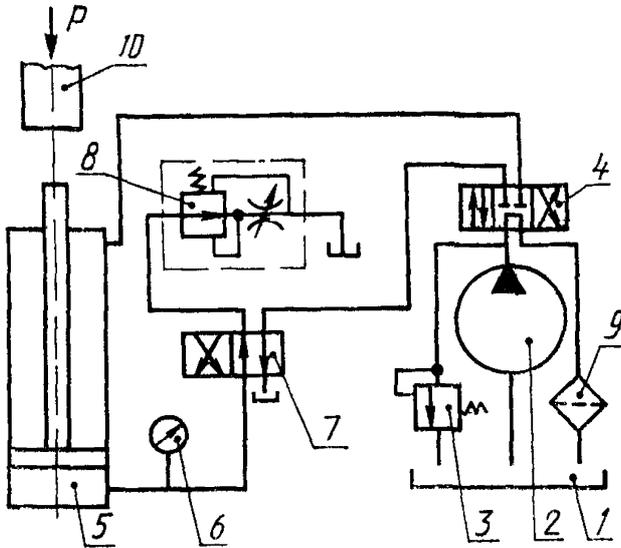
1 — бак 2 — насос 3 — предохранительный гидроклапан 4 — гидрораспределитель 5 — гидроцилиндр 6 — прибор для измерения давления класса точности 2,5, 7 — гидрораспределитель 8 — регулятор потока 9 — гидроочиститель 10 — буровой став
