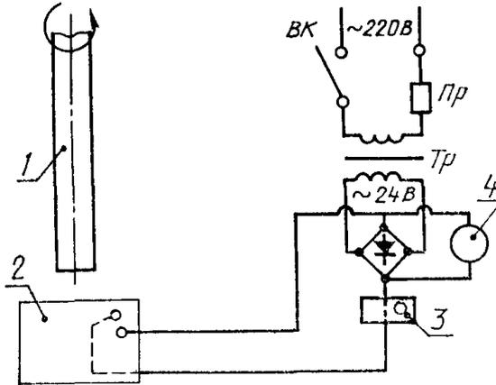
1 — буровой став; 2 — датчик импульсов; 3 — счетчик импульсов; 4 — электросекундомер
