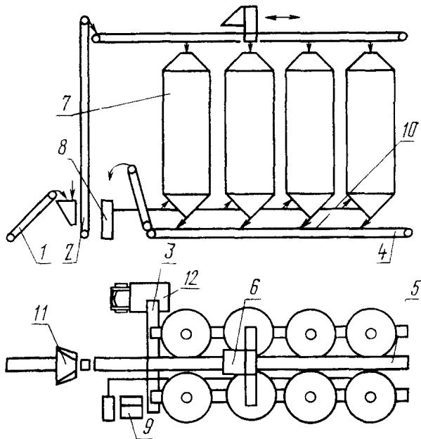
1—5—устройства транспортирования кормов, 6—устройство распределения 7—бункеры, 8—оборудование создания РГС (РТ), 9—система управления, 10—система разводки РГС (РТ) 11—устройство приемки, 12—автотранспорт
