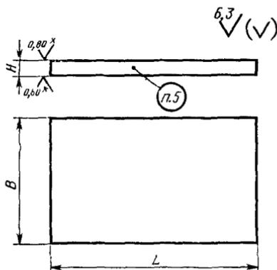
\* Для плит с припуском на окончательную обработку по высоте  $H$  шероховатость поверхности  $Ra=1,6$  мкм.
