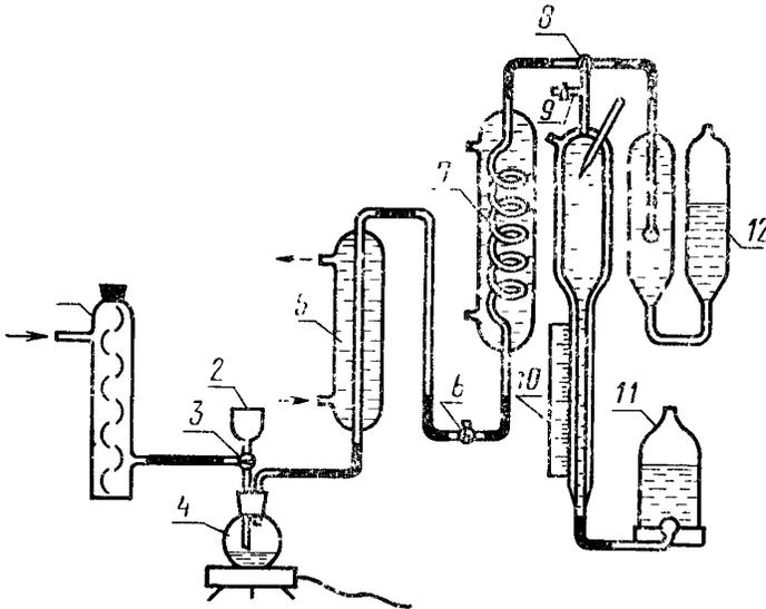
1—колонка для очистки воздуха заполненная аскаритом; 2—воронка; 3—кран; 4—колба для разложения навески, вместимостью 50 см<sup>3</sup>, плотно закрывающаяся резиновой пробкой с двумя отверстиями для воронки и отводной трубки; 5—холодильник; 7—змеевиковый холодильник; 6—8—двухходовые краны; 9—одноходовой кран; 10—газонизмерительная бюретка (эвдиометр) с термометром; 11—уравнительная склянка; 12—поглотительный сосуд.
