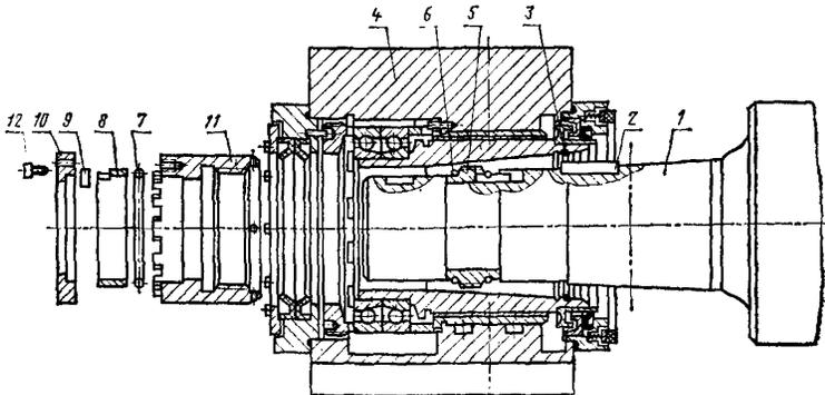
1—валок; 2—шпонка; 3—шнур; 4—подушка с ПЖТ; 5—резьбовые полукольца; 6—пружина; 7—шнур; 8—кольцо; 9—шпонка; 10—крышка; 11—гайка; 12—болты
