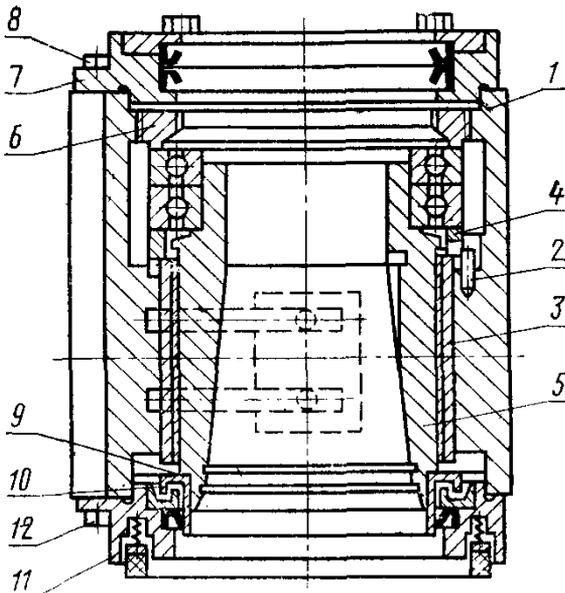
1—подушка; 2—штифт; 3—втулка-вкладыш; 4—кольцо; 5—узел втулки-цапфы; 6—гайка; 7—узел передней крышки; 8—болты; 9—шнур; 10—насадка; 11—узел задней крышки; 12—болты
