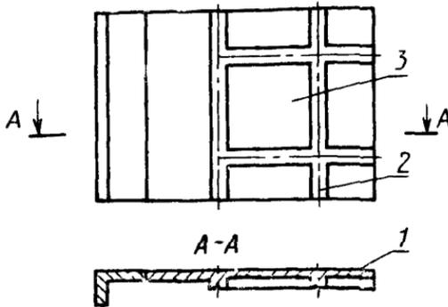
1—полотно панели, 2—ребро панели, 3—ячейка панели,
