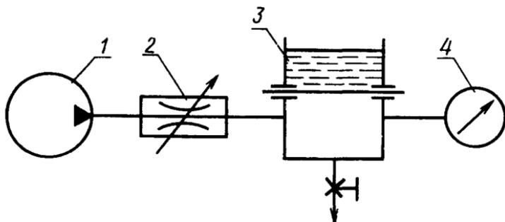
1 — источник сжатого воздуха; 2 — регулятор давления, 3 — устройство для закрепления испытуемого образца; 4 — манометр
