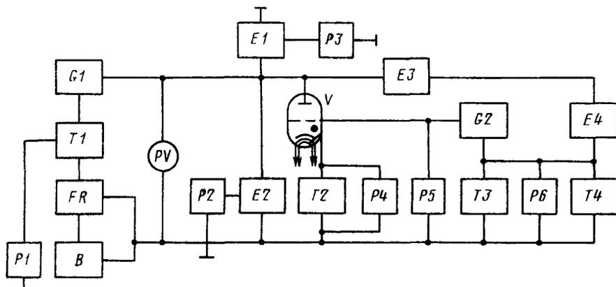
*B*—счетчик электрических импульсов; *E1*—устройство для измерения напряжения поддержания разряда; *E2*—делитель напряжения; *E3*—накопитель электрической энергии; *E4*—сопротивление нагрузки; *FR*—максимальное электрическое реле; *G1*—источник анодного напряжения; *G2*—источник напряжения сетки; *P1*—*P6*—осциллографы; *T1*—*T4*—измерительные трансформаторы тока или измерительные резисторы; *V*—испытываемый таситрон; *PV*—вольтметр
