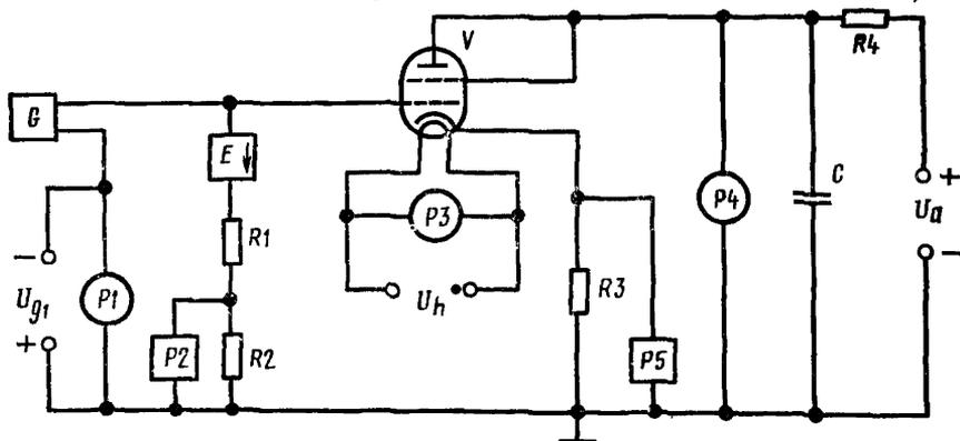
$C$ —накопительный конденсатор;  $G$ —генератор импульсов;  $P1, P3, P4$ —приборы для измерения постоянного (переменного) напряжения;  $P2, P5$ —приборы для измерения импульсного напряжения;  $R1R2$ —делитель напряжения;  $R3$ —измерительный резистор;  $R4$ —зарядный резистор;  $V$ —испытываемая лампа;  $E$ —электровакuumный или полупроводниковый диод.
