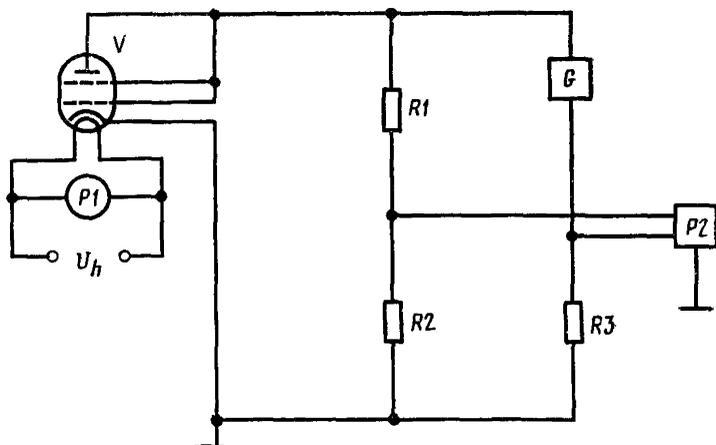
*G*—генератор импульсов; *P1*—прибор для измерения постоянного (переменного) напряжения, *P2*—электронный осциллограф; *R1R2*—делитель напряжения, *R3*—измерительный резистор, *V*—испытуемая лампа
