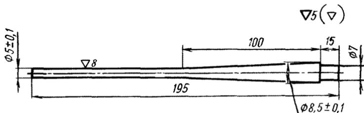
4.4. Технологическая проба волочением должна производиться путем волочения образцов на стане однократного волочения или разрывной машине через фильеру с углом рабочего конуса 15—25° и диаметром калибрующего пояса  $5 \pm 0,2$  мм до разрыва в цилиндрической части, после чего производят замер протянутой части образца.
