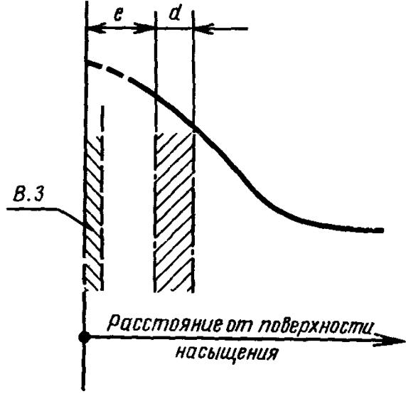
*d* — толщина зоны (мерного участка) диффузионного слоя; *e* — глубина залегания зоны (мерного участка) диффузионного слоя; *B. 3.* — внешняя зона диффузионного слоя.
