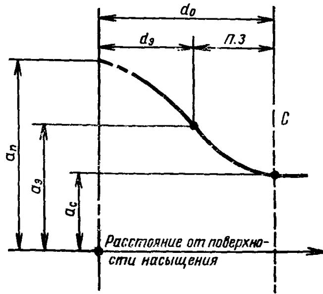
*П. З* — переходная зона диффузионного слоя; *C* — сердцевина, *d<sub>0</sub>* — общая толщина диффузионного слоя, *d<sub>3</sub>* — эффективная толщина диффузионного слоя; *a<sub>p</sub>* — значение базового параметра у поверхности; *a<sub>3</sub>* — предельное значение базового параметра, установленное для эффективной толщины; *a<sub>c</sub>* — значение базового параметра сердцевины.
