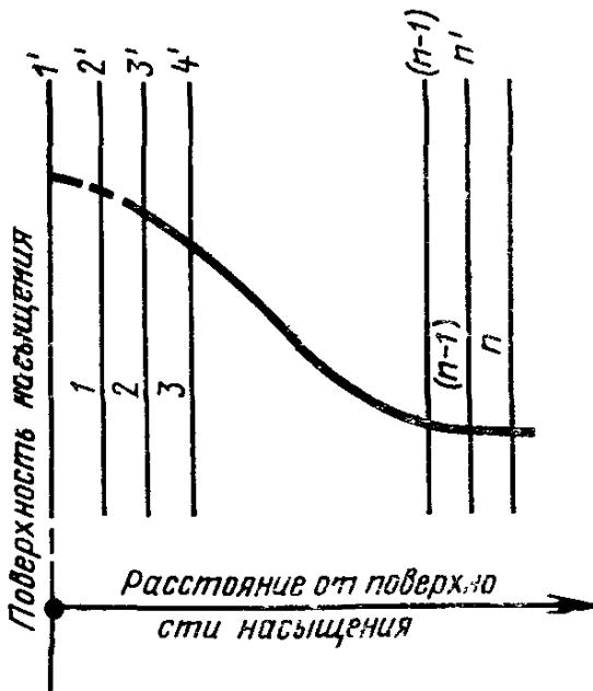
1, 2, 3 ... (n-1) — номера участков диффузионного слоя, последовательно удаляя которых и исследуя по составу,
