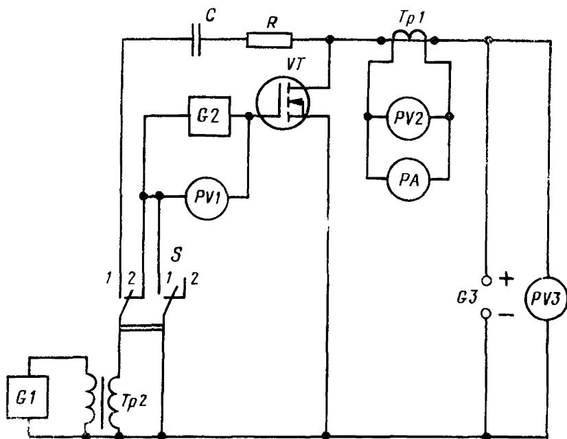
*C*—разделительный конденсатор, *R*—резистор; *Tr1*—импульсный трансформатор тока, *G2*—источник импульсного напряжения, *VT*—измеряемый транзистор, *PV2*—измеритель переменного напряжения; *PV1*—импульсный вольтметр, *PA*—импульсный измеритель тока, *S*—переключатель, *G3*—источник постоянного напряжения, *PV3*—вольтметр постоянного тока, *G1*—генератор, *Tp2*—трансформатор переменного напряжения
