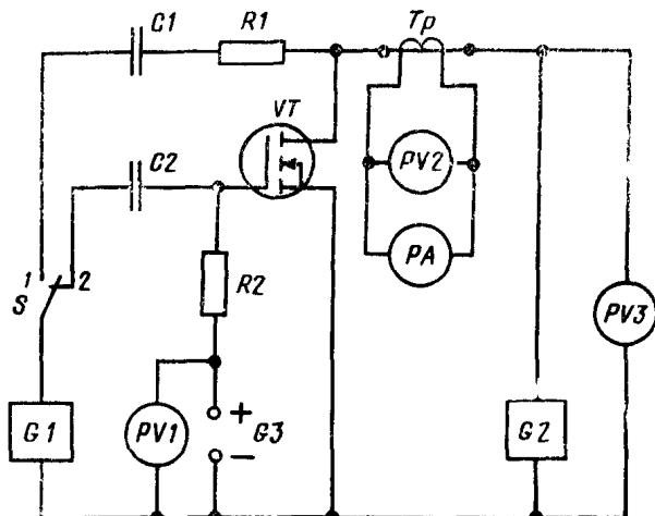
*C<sub>1</sub>, C<sub>2</sub>*—разделительные конденсаторы, *R<sub>1</sub>, R<sub>2</sub>*—резисторы, *T<sub>p</sub>*—импульсный трансформатор тока, *VT*—измеряемый транзистор, *PV<sub>2</sub>*—измеритель переменного напряжения, *S*—переключатель, *PA*—импульсный измеритель тока, *PV<sub>3</sub>*—импульсный вольтметр, *G<sub>1</sub>*—генератор, *PV<sub>1</sub>* вольтметр постоянного тока, *G<sub>2</sub>*—источник импульсного напряжения
