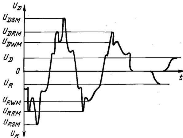
$U_D$  — постоянное напряжение в открытом состоянии;  $U_{DWM}$  — рабочее импульсное напряжение в закрытом состоянии;  $U_{DRM}$  — повторяющееся импульсное напряжение в закрытом состоянии;  $U_{DSM}$  — неповторяющееся импульсное напряжение в закрытом состоянии;  $U_R$  — постоянное обратное напряжение;  $U_{RWM}$  — рабочее импульсное обратное напряжение;  $U_{RRM}$  — повторяющееся импульсное обратное напряжение;  $U_{RSM}$  — неповторяющееся импульсное обратное напряжение
