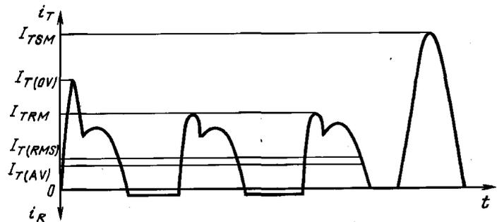
$I_{T(AV)}$  — средний ток в открытом состоянии;  $I_{T(RMS)}$  — действующий ток в открытом состоянии;  $I_{TRM}$  — повторяющийся импульсный ток в открытом состоянии;  $I_{T(OV)}$  — ток перегрузки в открытом состоянии;  $I_{TSM}$  — ударный ток в открытом состоянии
