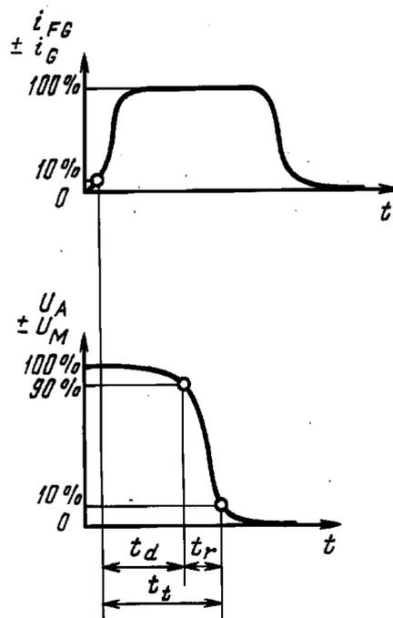
$t_d$  — время задержки по управляющему электроду;  $t_r$  — время нарастания по управляющему электроду;  $t_t$  — время включения по управляющему электроду.
