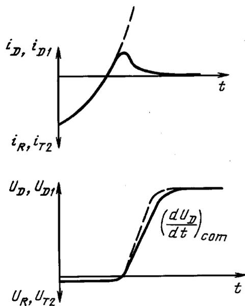
$\left(\frac{dU_D}{dt}\right)_{com}$  — критическая скорость нарастания коммутационного напряжения.
