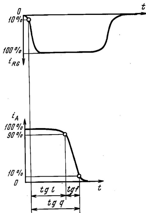
$t_{gl}$  — время запаздывания по управляющему электроду;  $t_{gr}$  — время спада по управляющему электроду;  $t_{gq}$  — время запирания по управляющему электроду.
