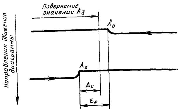
4.4. Основную погрешность приборов по записи времени (пп. 1.4; 1.5) следует определять при движущейся диаграммной ленте в нормальных условиях применения с учетом следующих требований.
