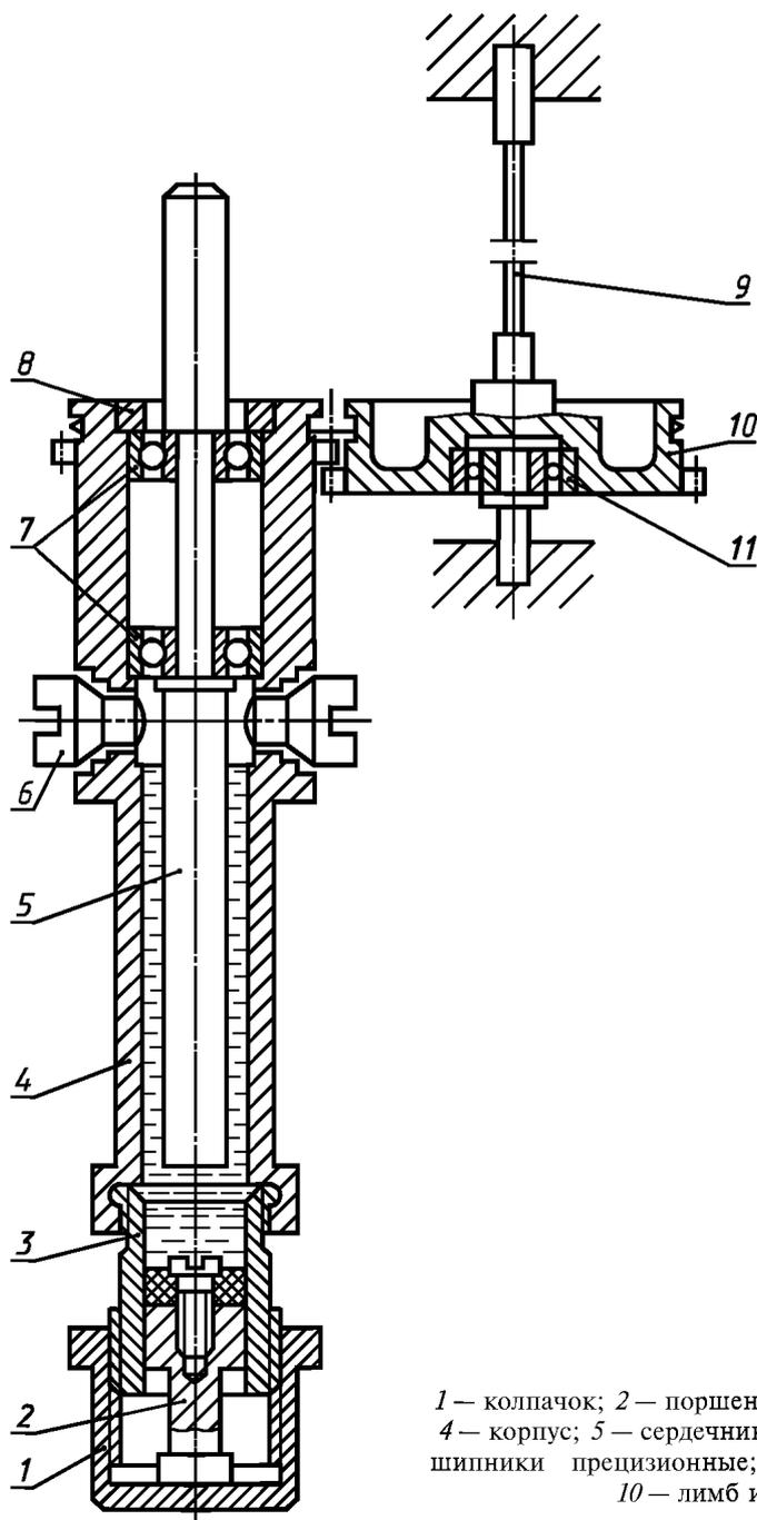
2.7. Торсион нужного диаметра закрепляют одним концом на лимбе, а другим — на штативе прибора; корпус прибора соединяют с измерительным лимбом ниткой. При применении торсиона диаметром 0,9 мм и более вводят в зацепление зубчатое колесо. Стрелку, фиксирующую показания лимба, устанавливают на ноль.
