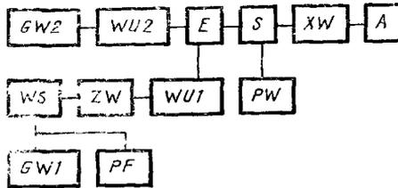
GW1—генератор СВЧ мощности; PF—частотомер; WS—вентиль; ZW—фильтр СВЧ или другое устройство, обеспечивающее подавление шумов генератора GW1; WU1—переменный аттенуатор; GW2—генератор шума; WU2—прецизионный аттенуатор; E—направленный ответвитель; S—переключатель СВЧ; PW—измеритель мощности; XW—измерительная диодная камера с диодом; A—усилитель промежуточной частоты
