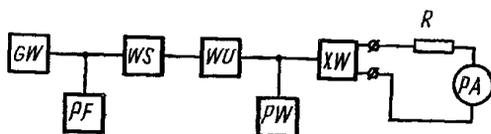
*GW*—генератор СВЧ мощности; *PF*—частотомер; *WS*—ферритовый вентиль; *WU*—переменный аттенюатор; *PW*—измеритель мощности; *XW*—измерительная диодная камера; *R*—дополнительный резистор; *PA* — миллиамперметр.
