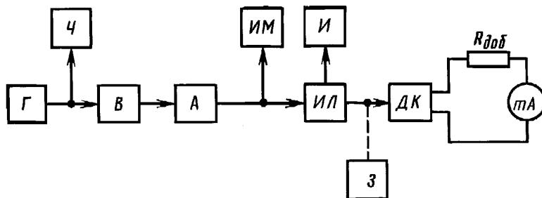
*Г — генератор СВЧ; Ч — частотомер; В — ферритовый вентиль; А — переменный аттенюатор; ИМ — измеритель мощности; ИЛ — измерительная линия; И — индикаторный прибор; ДК — измерительная диодная камера; R<sub>доб</sub> — добавочный резистор; mA — миллиамперметр постоянного тока; З — замыкатель (из комплекта измерительной линии)*
