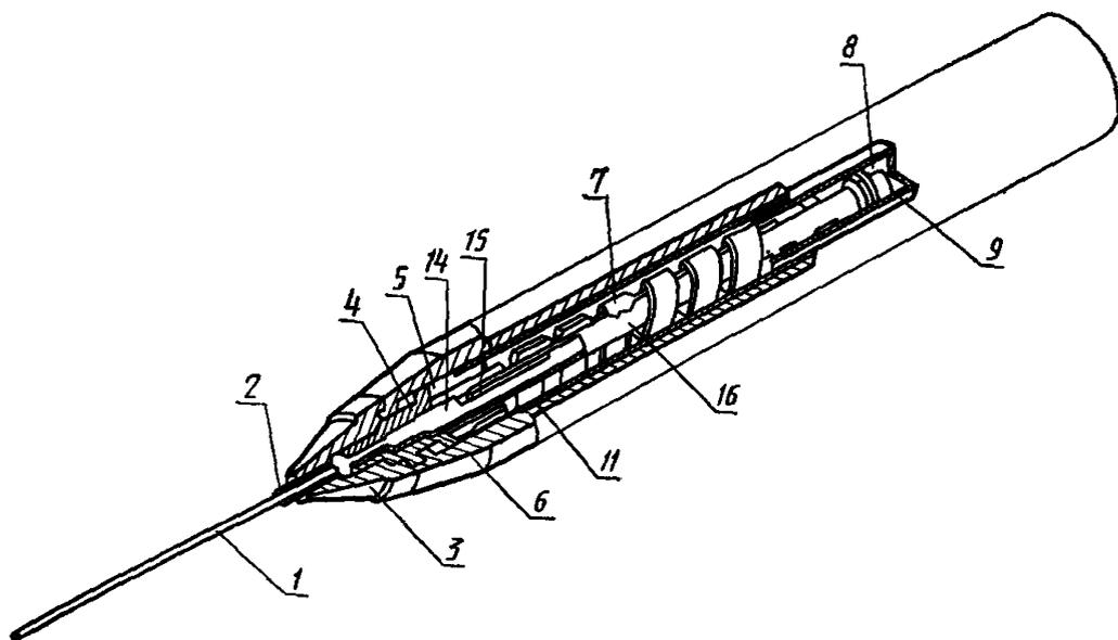
1 — грифель; 2 — трубчатая направляющая; 3 — металлический наконечник; 4 — соединительная втулка; 5 — втулка (вкладыш); 6 — нижний корпус (нижняя часть корпуса); 7 — винтовая поверхность (спираль); 8 — упор (фиксатор) спирали; 9 — кожух спирали; 10 — держатель (оправка) гильзы; 11 — гильза; 12 — верхний корпус (верхняя часть корпуса); 13 — манжета для установки ластика; 14 — трубка для грифеля (с трубчатой направляющей); 15 — выталкиватель; 16 — трубка с прорезью; 17 — ластик
