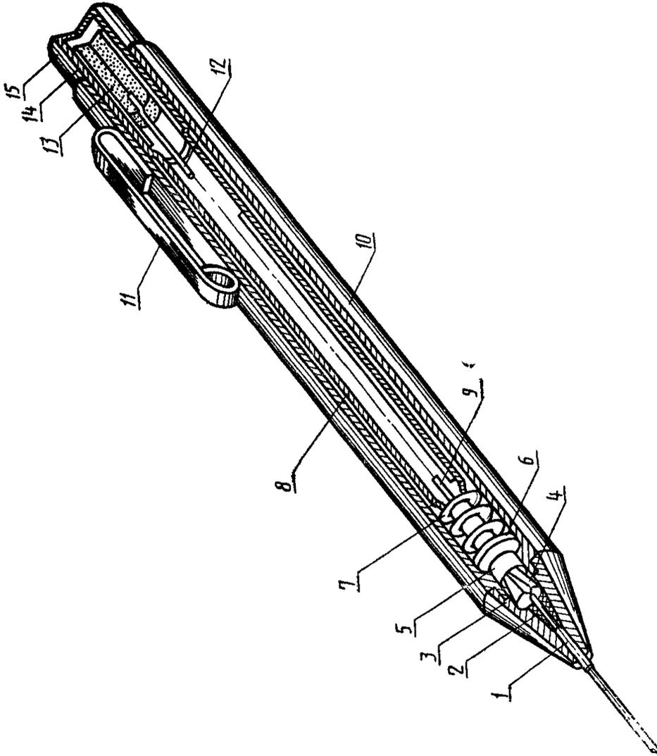
1 — трубчатая направляющая; 2 — фиксатор (держатель) грифеля; 3 — металлический наконечник; 4 — зажимной патрон (цанга); 5 — кольцо (обод) зажимного патрона; 6 — соединительная втулка; 7 — пружина; 8 — трубка для грифеля; 9 — грифель; 10 — корпус; 11 — держатель; 12 — прочищающая шпилька; 13 — ластик; 14 — манжета для установки ластика; 15 — кнопка приведения в действие механизма выдвижения
