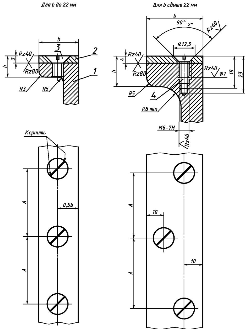
1 — корпус; 2 — броня; 3 — винт В.М6 — 8g × 12.58.05 по ГОСТ 17475—80; 4 — винт В.М6 — 8g × 16.58.05 по ГОСТ 17475—80
