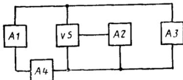
*A1*—устройство задания режима в цепи основных выводов тиристора, *VS*—испытуемый тиристор, *A2*—устройство задания режима в цепи управления, *A3*—измерительное устройство для измерения времени включения, нарастания и задержки по напряжению, *A4*—измерительное устройство для измерения времени включения, нарастания и задержки по току
