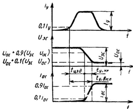
$I_y$ —ток управления,  $I_{oc}$ —ток в открытом состоянии,  $U_{oc}$ —напряжение в закрытом состоянии
