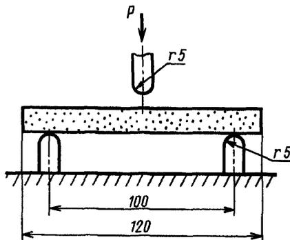
3.3. Испытания проводят при скорости перемещения нагружающего индентора  $(10 \pm 2)$  мм/мин.
