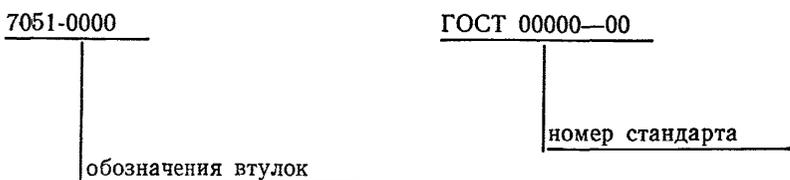
Для втулок под направление зенкеров и разверток допускается вводить дополнительно обозначение — индекс назначения, устанавливаемый по таблице.
