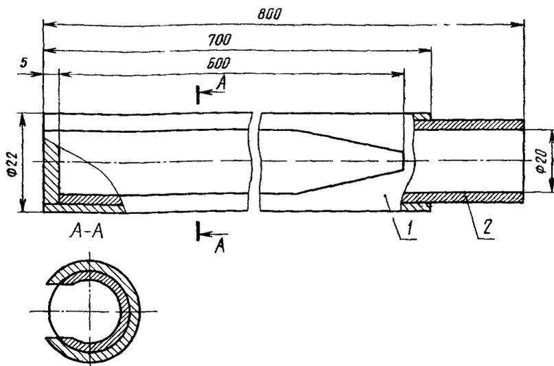
1 — внешняя трубка; 2 — внутренняя трубка
