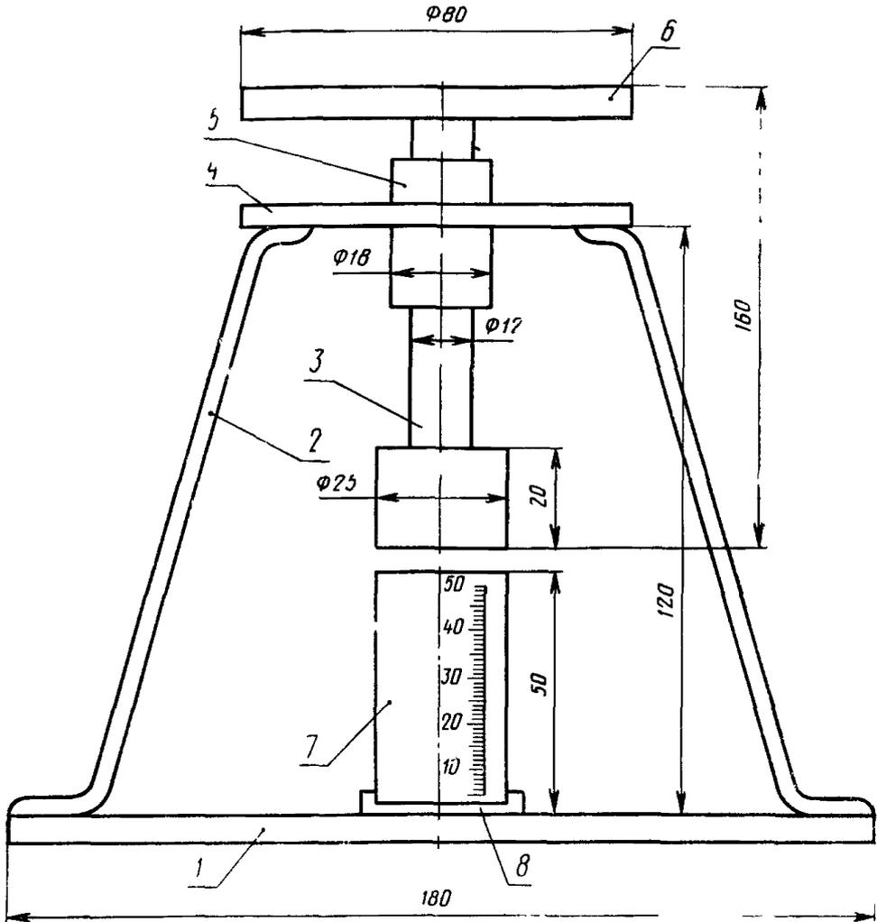
1 — основание прибора; 2 — стойка; 3 — плунжер со штоком; 4 — диск для крепления втулки; 5 — направляющая стойка; 6 — площадка для груза; 7 — цилиндр; 8 — подставка под цилиндр
