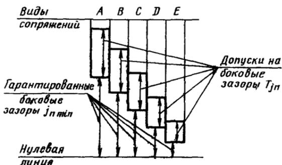
1.6. Точность изготовления глобоидных передач задается степенью точности, а требования к боковому зазору — видом сопряжения по нормам бокового зазора.
