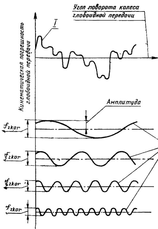
I—кривая кинематической погрешности глобоидной передачи; II—гармонические составляющие кинематической погрешности глобоидной передачи для разных значений  $k$
