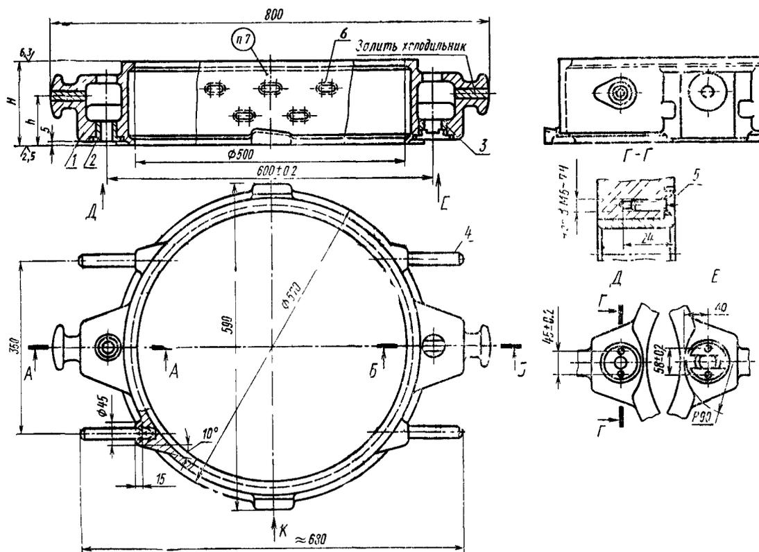
1 — корпус; 2 — центрирующая втулка 0290-2621 по ГОСТ 15019 (1 шт.); 3 — направляющая втулка 0290-2631 (по требованию потребителя 0290-2632) по ГОСТ 15019 (1 шт.); 4 — ручка 0298-0301 по ГОСТ 15022 (4 шт.); 5 — винт А.М6—6g×20.58 05 по ГОСТ 17475 (4 шт.); 6 — вентиляционные отверстия: 2 ряда для опок высотой 150 мм, 3 ряда для опок высотой 200 мм (по требованию потребителя допускается вентиляционные отверстия не делать)
