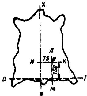
1.8. В зависимости от толщины в стандартной точке *H* (см. чертеж) кожи подразделяют на тонкие, средние, толстые и особо толстые в соответствии с табл. 1.
