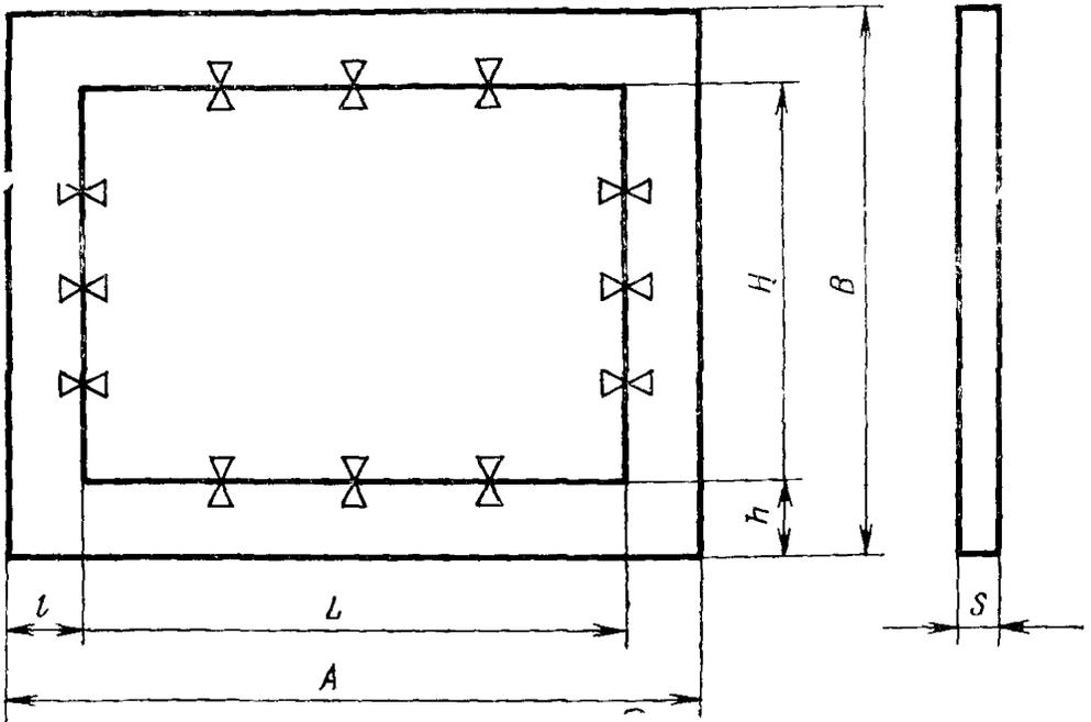
$H$ —высота рабочего поля;  $L$ —ширина рабочего поля  $A$ —габаритный размер таблицы по горизонтали,  $B$ —габаритный размер таблицы по вертикали,  $h$ —расстояние от границы рабочего поля до края таблицы по вертикали,  $l$ —расстояние от границы рабочего поля до края таблицы по горизонтали,  $S$ —толщина таблицы
