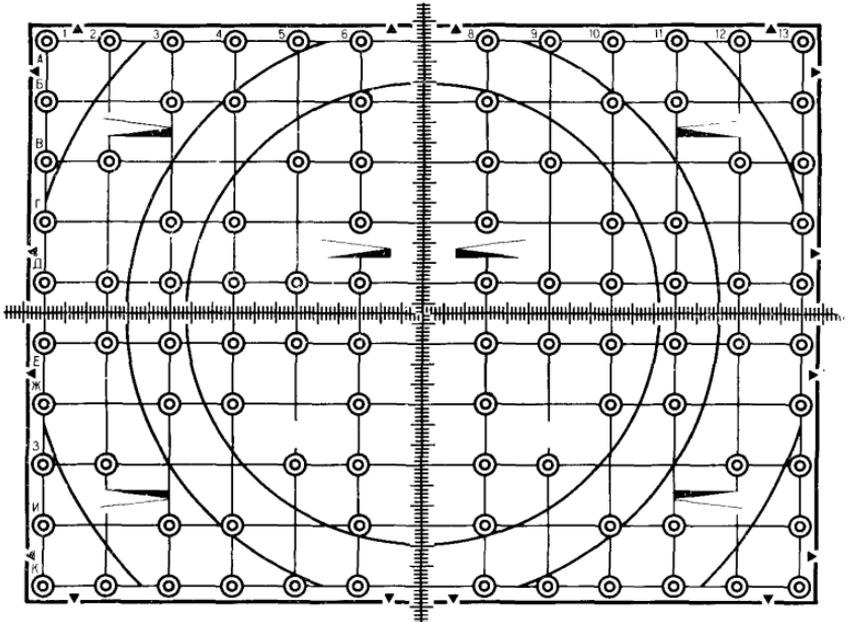
**ПРИМЕР ПОСТРОЕНИЯ ИСПЫТАТЕЛЬНОЙ ТАБЛИЦЫ
