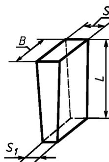
Рисунок 2 — Двусторонний торцовый клин
