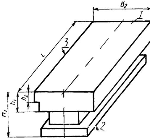
$L_1 \geq 0,6 I$ , но не более 710 мм,  $B_2 \geq 0,6 B_1$ , но не более 300 мм,  $H_1 \geq 0,3 H$ , но не более 200 мм,  $h_1 \approx 0,4 H_1$ ,  $h_2 \approx 0,5 h_1$ , где  $L$  — длина стола,  $B_1$  — ширина стола,  $H$  — наибольшая высота шлифования
