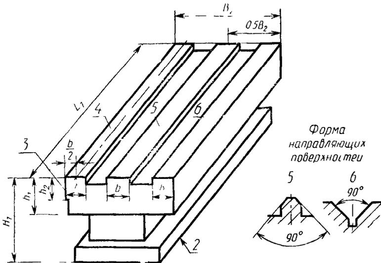
$L_1 \geq 0,6 L$ , но не более 1250 мм,  $B_2 \geq 0,6 B$ , но не более 500 мм,  $b \geq 0,15 B_2$ , но не менее 40 мм,  $H_1 \geq 0,3 H$ , но не более 500 мм  $h_1 \approx 0,4 H_1$ , но не менее 200 мм,  $h_2 \approx 0,5 h_1$ , но не менее 100 мм; где  $L$  — длина стола  $B$  — наибольшая ширина обрабатываемой заготовки,  $H$  — наибольшая высота обрабатываемой заготовки
