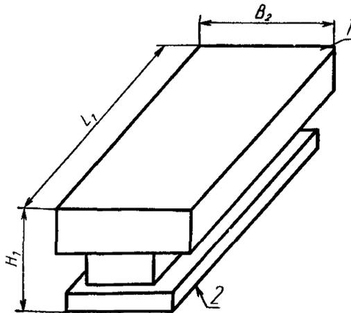
$L_1 \geq 0,6 L$ , но не более 710 мм,  $B_2 \geq 0,6 B_1$ , но не более 360 мм,  $H_1 \geq 0,3 H$ , но не более 300 мм, где  $I$  — длина стола,  $B_1$  — ширина стола,  $H$  — наибольшая высота шлифования
