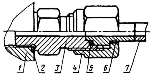
1 — гнездо, 2 — прокладка, 3 — штуцер, 4 — накидная гайка,
