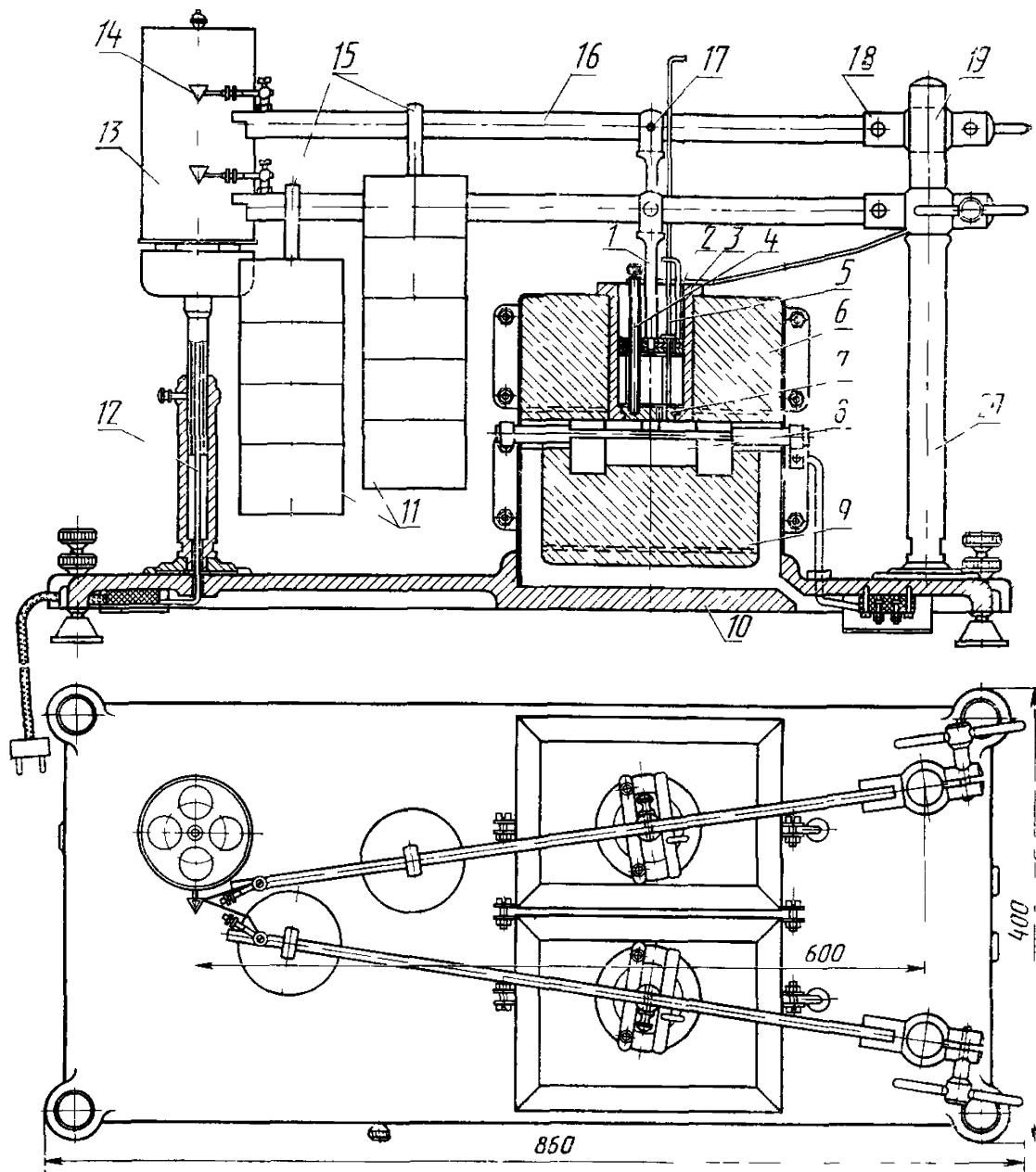
1—штемпель; 2—прижимная планка; 3—стакан; 4—трубка для термопары; 5—пластометр; 6—верхний кирпич; 7—дно стакана; 8—нагреватель; 9—нижний кирпич; 10—плита; 11—груз; 12—стойка барабана; 13—барабан с часовым механизмом; 14—перо; 15—подвеска груза; 16—рычаг; 17—шарнирный валок; 18—шарнирный валок; 19—муфта для крепления рычага; 20—стойка; 21—установочный винт
