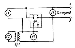
$\Gamma 1$ — генератор основной частоты;  $\Gamma 2$ — генератор кратной частоты;  $T \rho 1$ — трансформатор понижающий с коэффициентом трансформации в пределах от 5 до 10;  $\mathcal{B} O$ — электронный осциллограф; V1 и V2— контрольные вольтметры, показывающие среднеквадратическое значение напряжения; I и I0— зажимы для подключения испытуемого прибора
