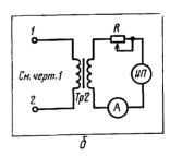
I и 2 — выходные зажимы устройства для получения напряжения несинусои-дальной формы (см. черт. 1);  $H\Pi$  — испытуемый прибор; Tp2 — трансформатор понижающий; R — сопротивление регулируемое (реостат); A — амперметр контрольный, показывающий среднеквадратическое значение тока.
