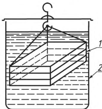
Камера из нержавеющей металлической сетки с размерами отверстий не более 2 мм<sup>2</sup> и диаметром проволоки для изготовления сетки 0,5 мм. Размеры камеры 93×80×60 мм.
