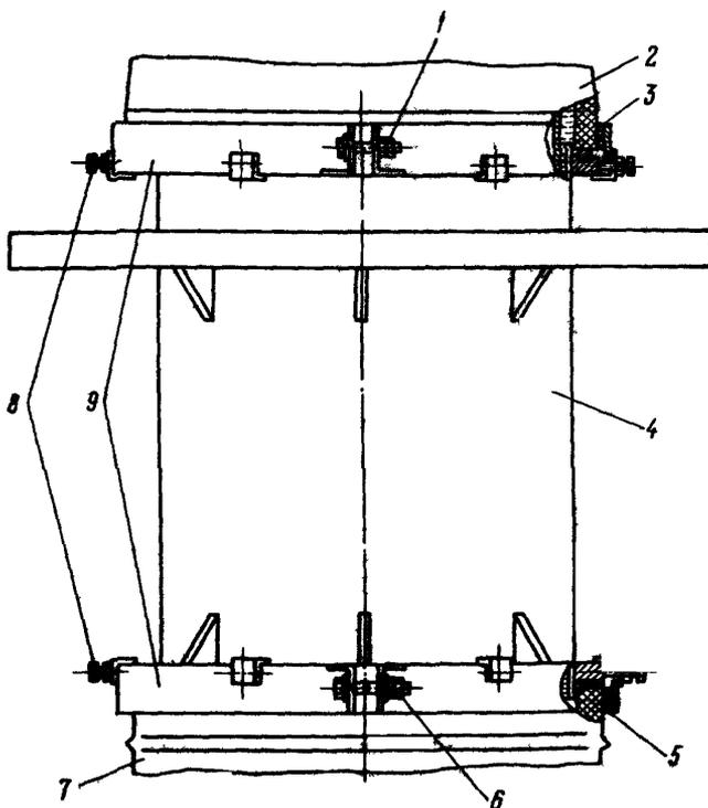
Рис.12. Узел крепления крышек вводов 220 кВ:
