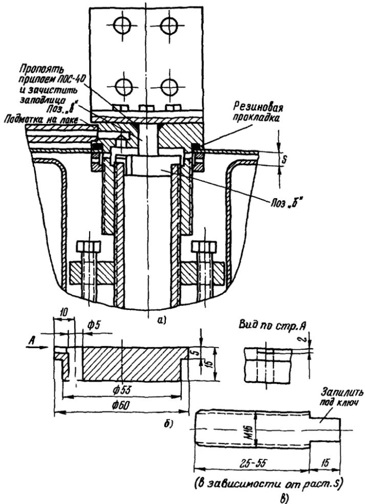
Рис.18. Реконструкция контактного соединения верхнего стакама с токоведущей трубой ввода МВ-110/600 зав.черт. № 132-0-0:
