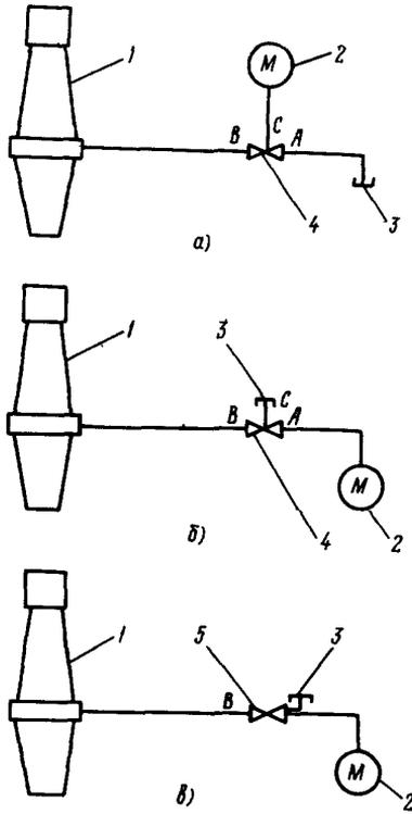
Рис.2. Гидравлические схемы герметичных вводов со встроенным расширителем:
