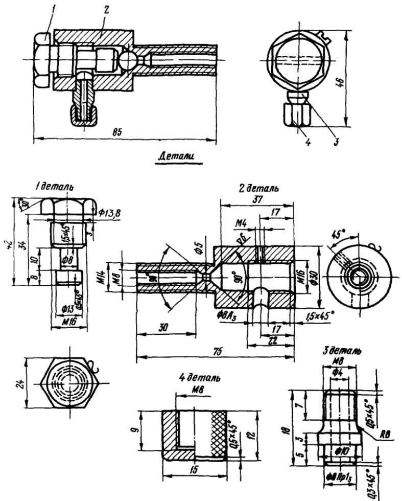
Рис.16. Маслоотборное устройство с резьбовым штуцером:
