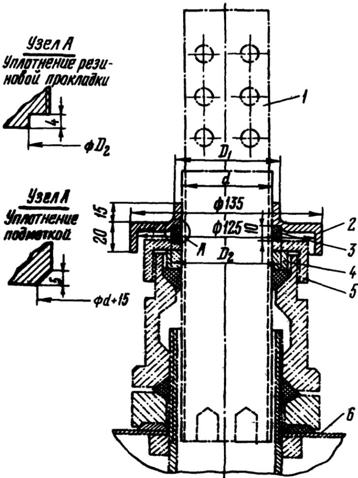
Рис. II. Реконструкция уплотнения верхнего узла вводов трансформаторов;
