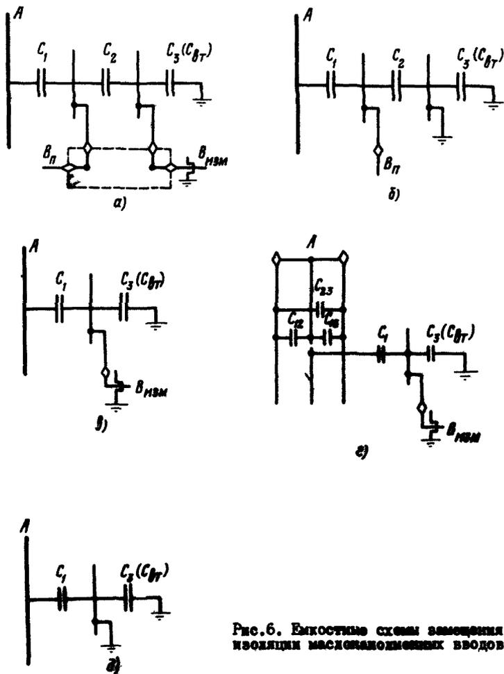
Рис.6. Емкостные схемы замещения изоляции масляных вводных
