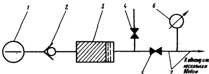
Рис.7. Схема проверки плотности негерметичных вводов скатым воздухом:
