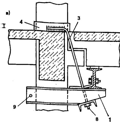
*а* — металлическими приспособлениями: *I* — закрепленными на колонне; *II* — закрепленными на балке; *1* — подвесная консоль; *2* — подпорка; *3* — несущий хомут; *4* — металлическая обойма; *5* — шайба-упор; *6* — подкладка; *7* — отверстие, заделываемое после установки приспособления; *8* — гайка; *9* — стяжной болт;
