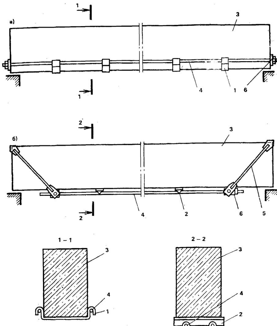
Рис. 35. Расположение напрягаемой арматуры при усилении конструкций
