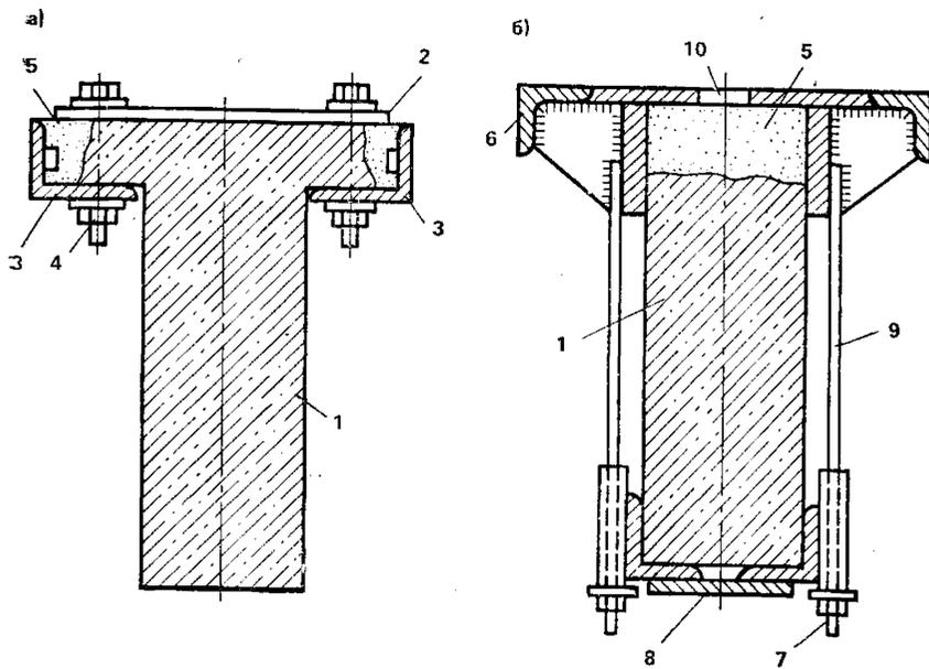
**Рис. 52. Усиление свесов полки тавровых подкрановых балок**
