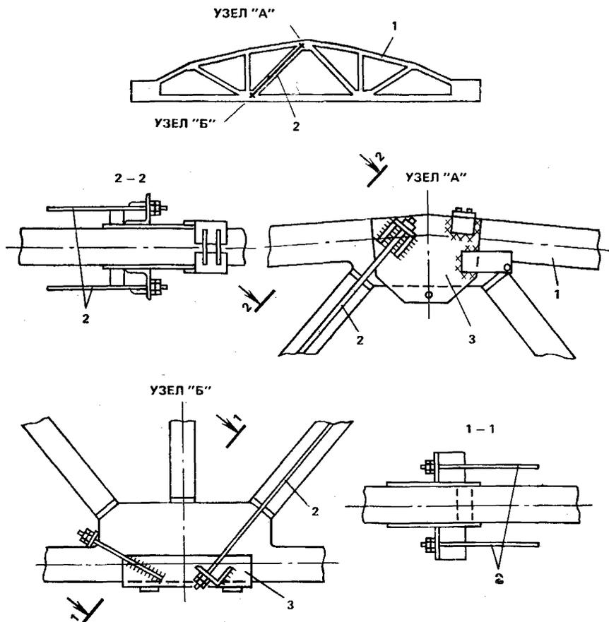
**Рис. 42. Усиление растянутых элементов решетки ферм**
