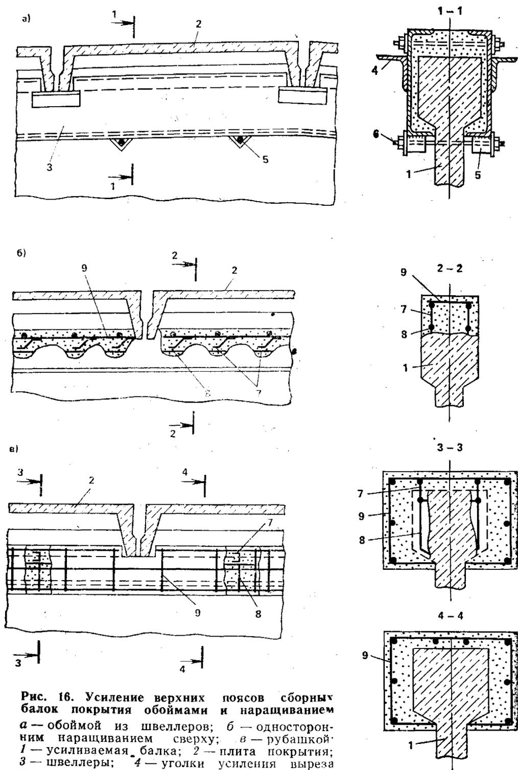
Рис. 16. Усиление верхних поясов сборных балок покрытия обоймами и наращиванием
