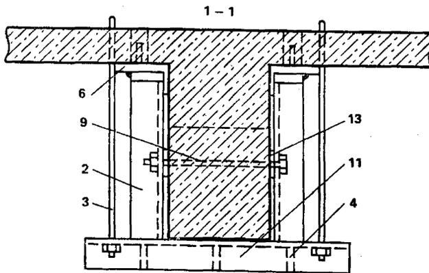
2 — подвесными металлическими подпорками; 1 — усиливаемый элемент; 2 — подпорка; 3 — несущий хомут; 4 — ребро жесткости; 5 — шайба-упор; 6 — подкладки из уголков; 7 — отверстие, заделываемое после установки подпорки; 8 — гайка; 9 — стяжной болт; 10 — подкладка; 11 — подвесной упор; 12 — клиновидная шайба; 13 — прокладка; 14 — горизонтальный упор
