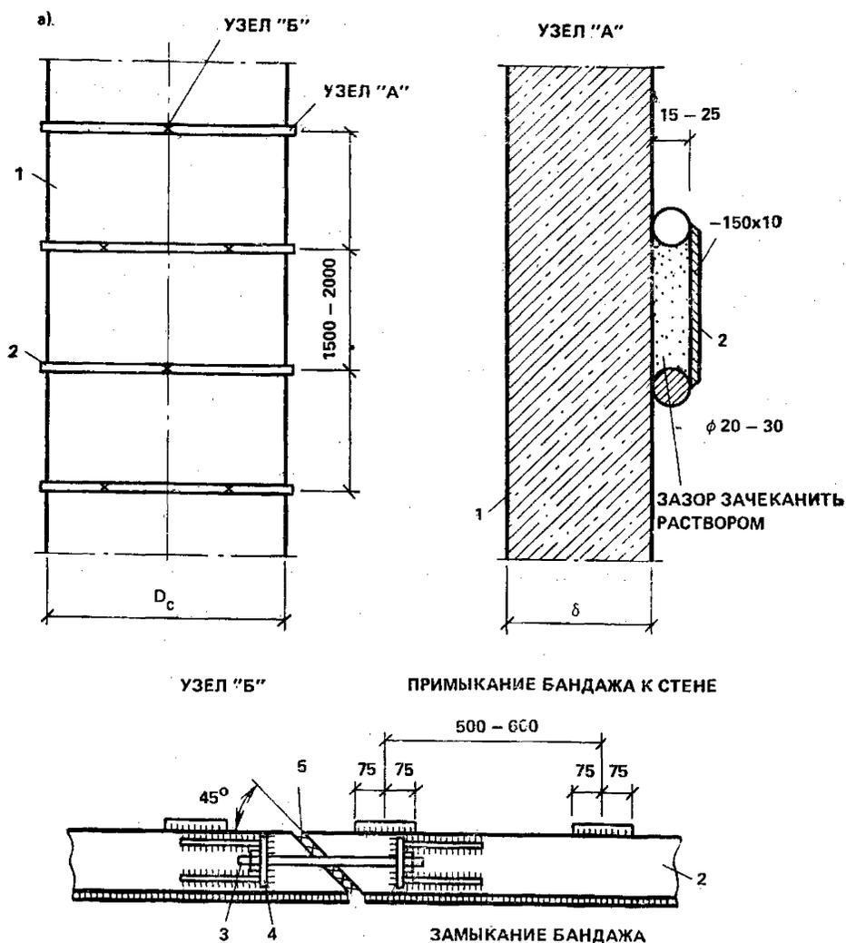
**Рис. 54. Усиление стен хранилищ**
