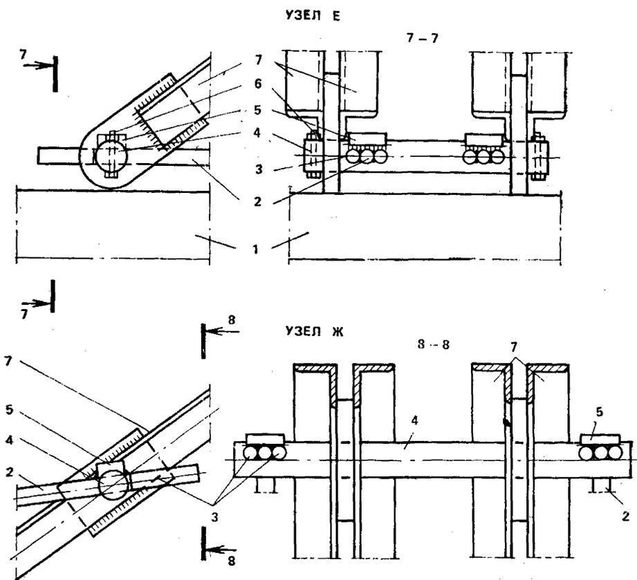
Рис. 34. Многопролетное рычажное усиливающее устройство
