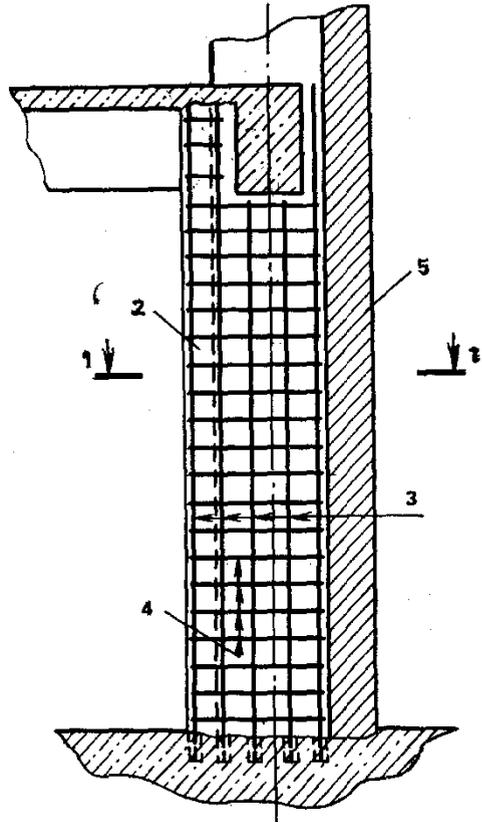
**Рис. 15. Усиление колонны железобетонной рубашкой**
