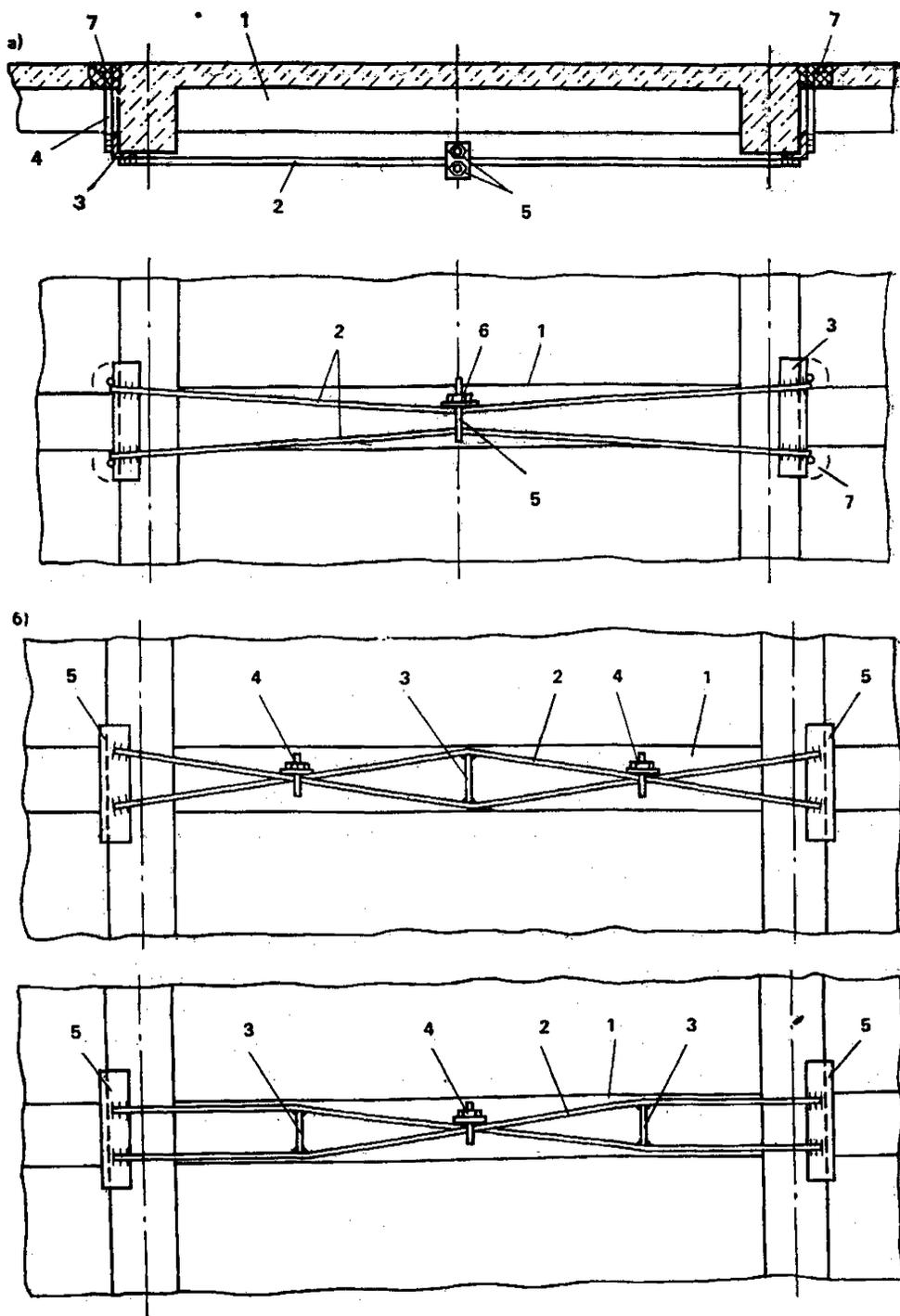
**Рис. 31. Усиление балки дополнительной предварительно напряженной арматурой**
