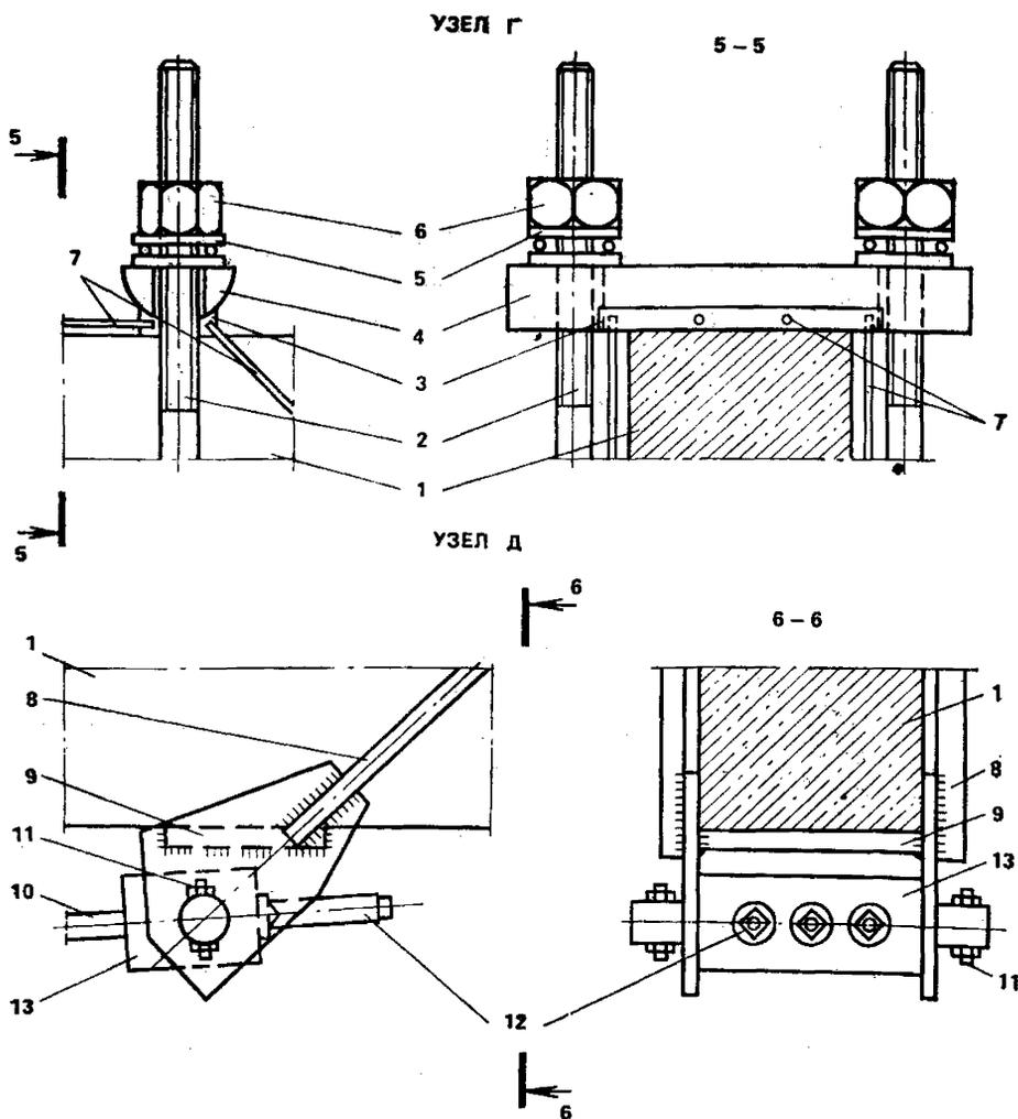
*узлы Г и Д:* 1 — усиливаемая конструкция; 2 — вертикальная тяга; 3 — подпятник шарнира; 4 — цилиндрический шарнир с пазами по торцам; 5 — упорный подшипник; 6 — гайка; 7 — монтажные связи; 8 — наклонные ветви опоры усиления; 9 — опорная подкладка; 10 — стержни затяжки; 11 — ограничительный болт; 12 — анкер стержня затяжки типа «обжатая гильза»; 13 — цилиндрический шарнир с коробом
