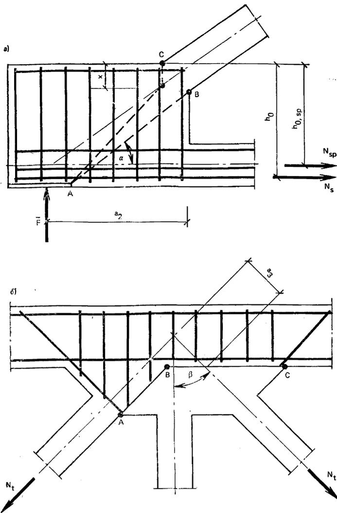
Рис. 67. Расчетные схемы узлов фермы
