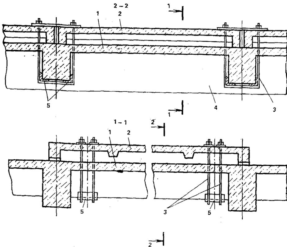
**Рис. 4. Полное разгружение плиты монолитного перекрытия ребристыми плитами**
