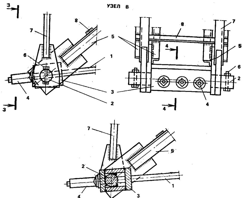
*узел В:* 1 — стержни затяжки; 2 — цилиндрический шарнир; 3 — короб усиления цилиндрического шарнира; 4 — анкер стержня затяжки типа «обжимная гильза»; 5 — рычаг; 6 — ограничительный болт; 7 — вертикальная тяга; 8 — соединительная планка;
