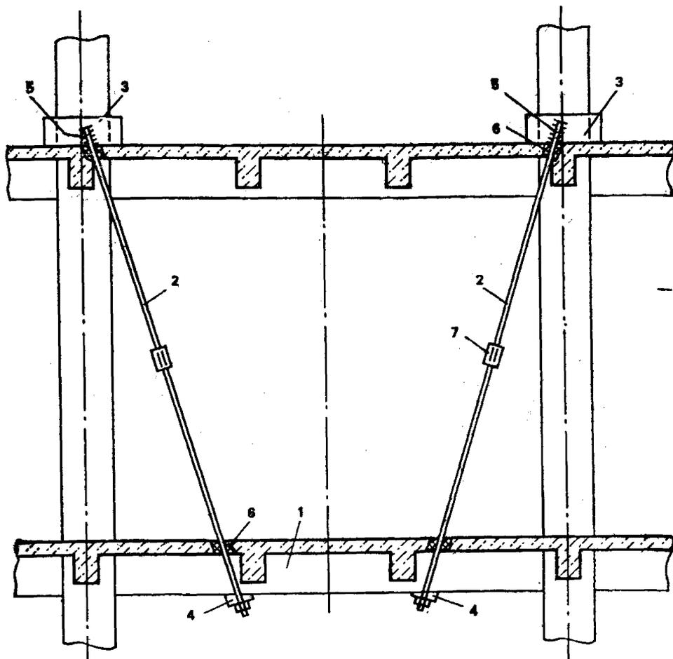
**Рис. 25. Усиление дополнительной упругой опорой (предварительно напряженными тяжами)**
