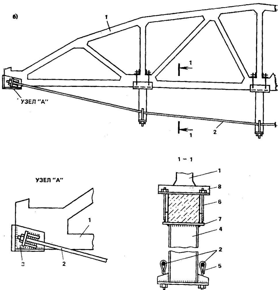
**Рис. 40. Усиление железобетонных ферм шарнирно-стержневыми цепями**
