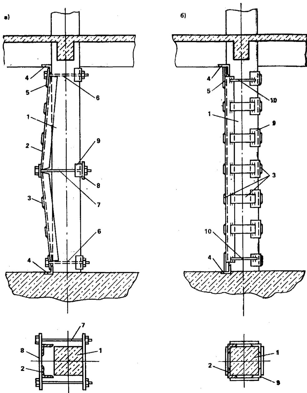
**Рис. 36. Усиление колонны предварительно напряженной односторонней металлической распоркой**
