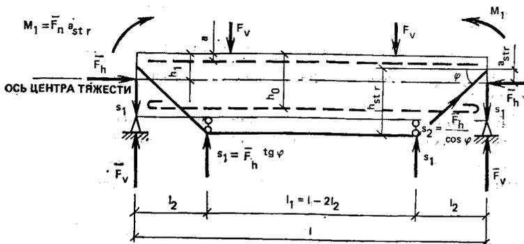
Рис. 62. Расчетная схема изгибаемого элемента, усиленного шпренгельной затяжкой
