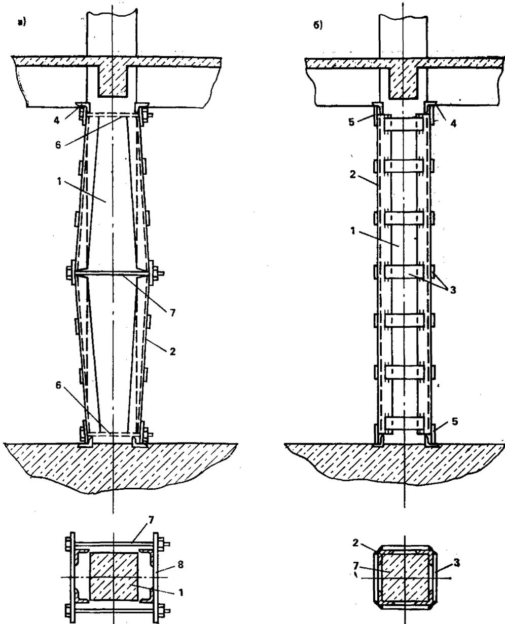
**Рис. 37. Усиление колонны предварительно напряженными двухсторонними металлическими распорками**
