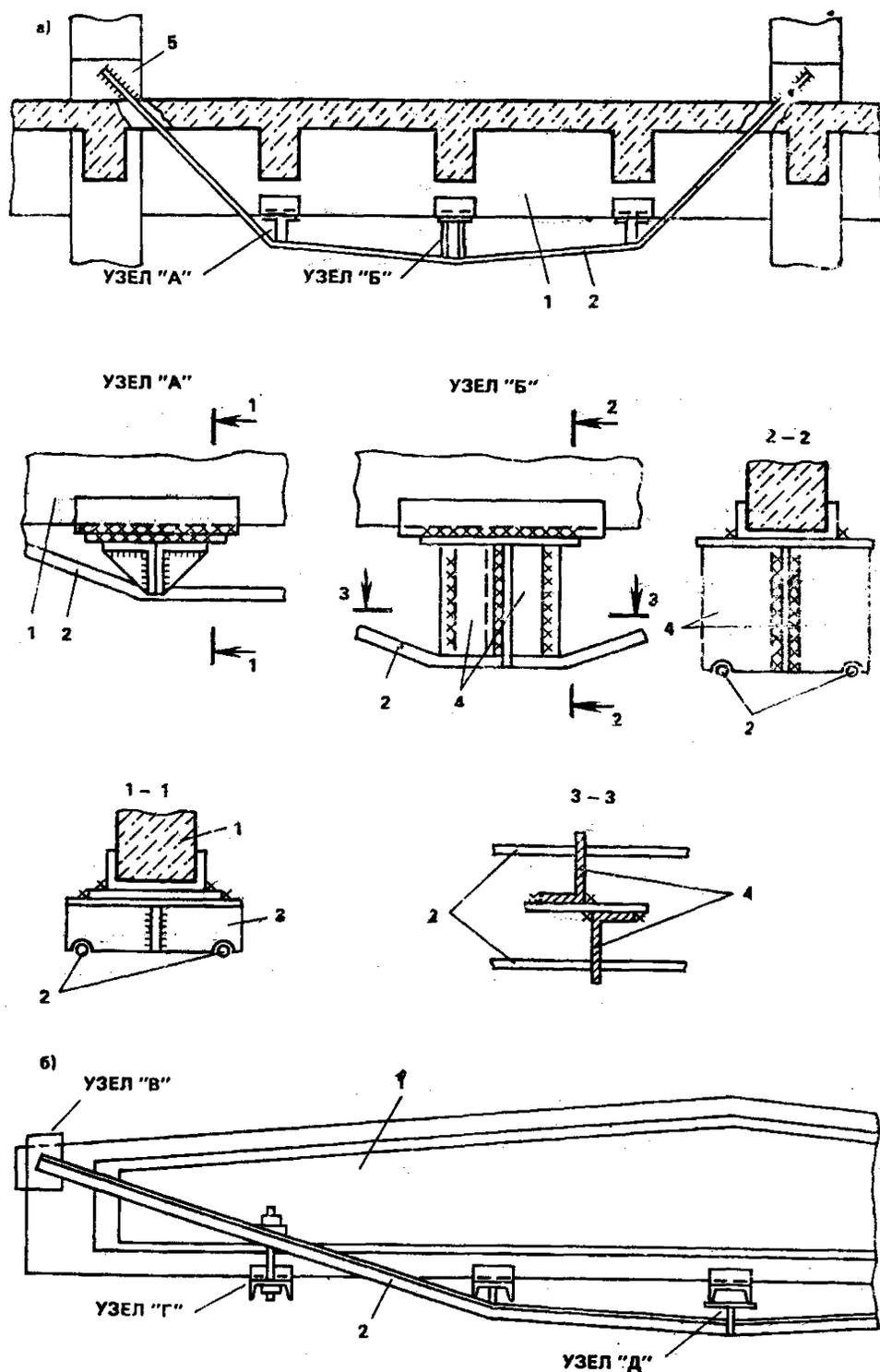
Рис. 27. Усиление изгибаемых элементов предварительно напряженной шарнирно-стержневой цепью
