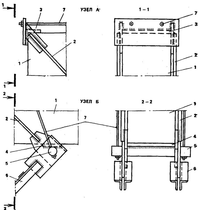
Рис. 33. Усиливающее устройство шпренгельного типа
