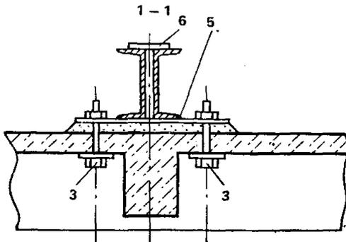
**Рис. 2. Полное разгружение железобетонной балки металлическими обоймами**
