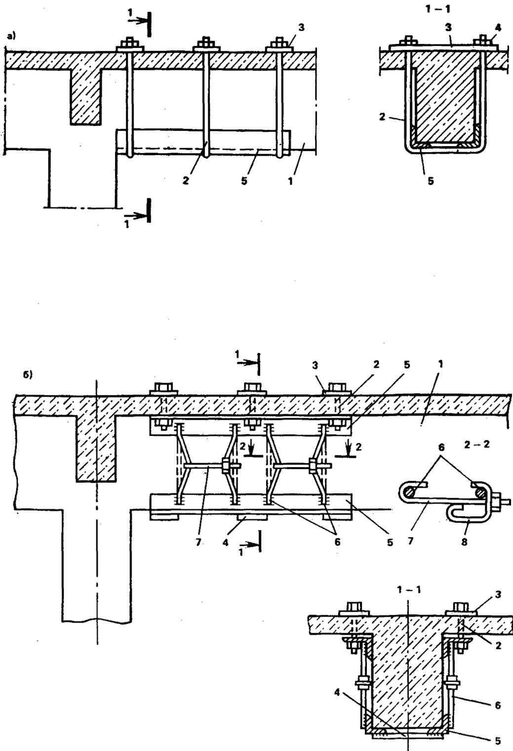
Рис. 38. Усиление балок на восприятие поперечных сил
