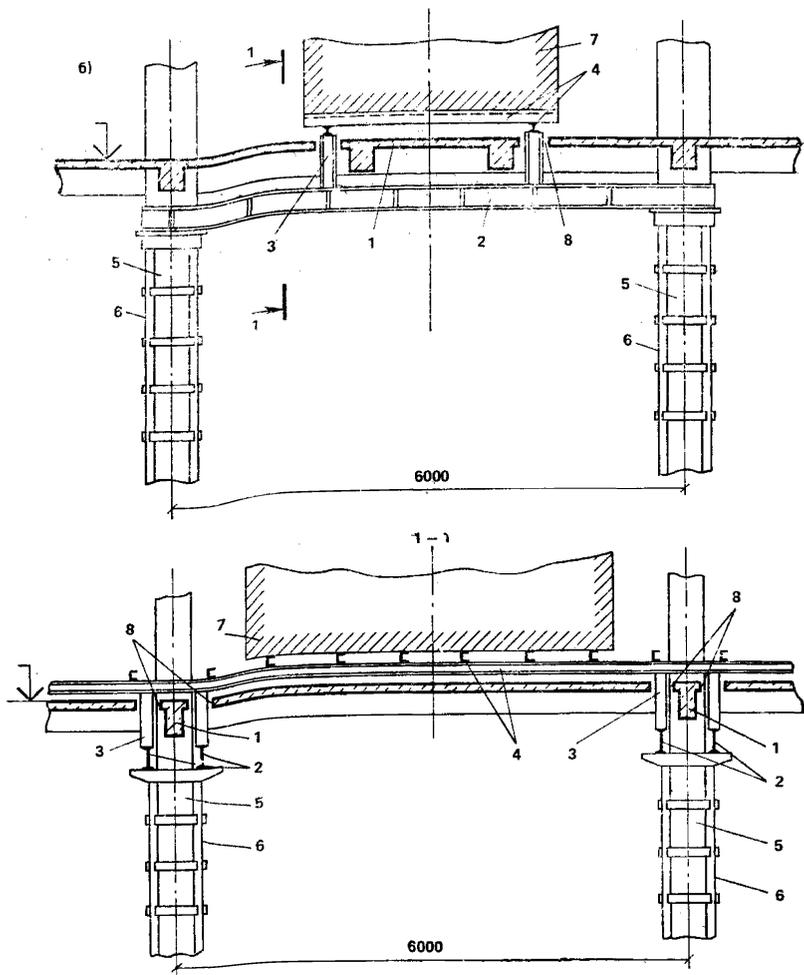
рых является охват усиливаемого элемента со всех четырех сторон (рис. 10—13). Обоймы могут быть железобетонными и металлическими.
