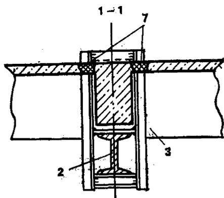
Рис. 24. Усиление изгибаемых элементов дополнительными упругими опорами
