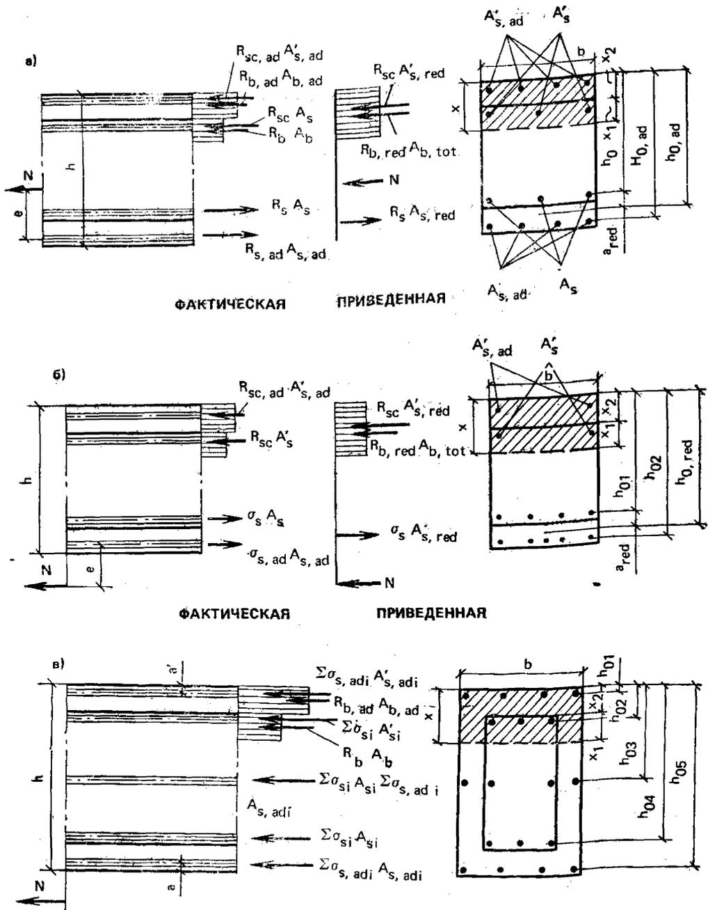
Рис. 65. Схемы усилий и эпюры напряжений в сечении, нормальном к продольной оси внецентренно сжатого элемента, при расчете его по прочности а — усиленного двухсторонним наращиванием при условии  $\xi \leq \xi_R$ ; б — то же, при условии  $\xi > \xi_R$ ; в — усиленного обоякой с расположением арматуры на различных уровнях, по общему случаю расчета
