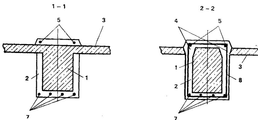
Рис. 10. Усиление монолитной балки железобетонной обоймой
