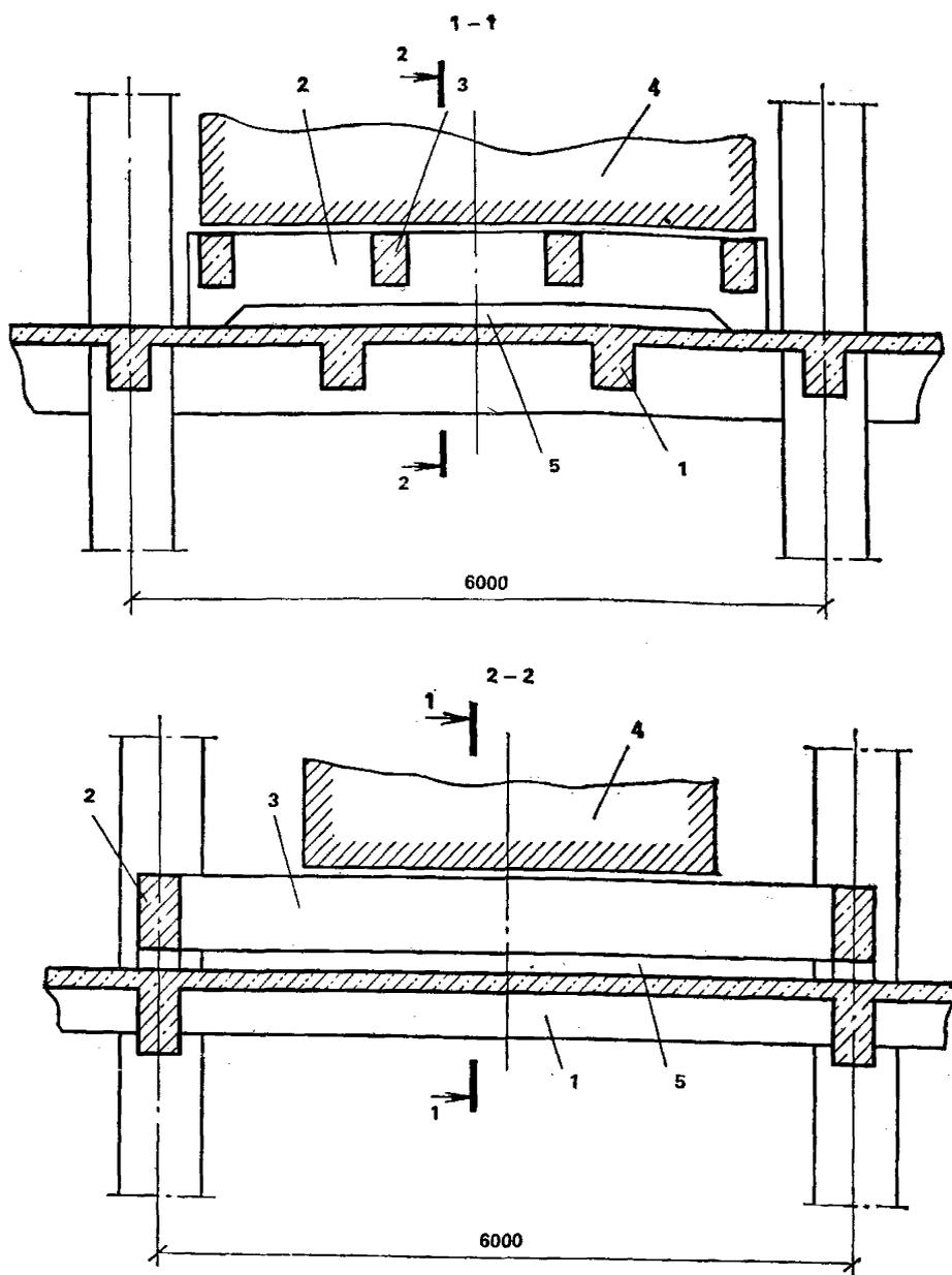
**Рис. 1.** Полное разгружение перекрытия железобетонными конструкциями 1 — разгружаемая конструкция; 2, 3 — разгружающая конструкция; 4 — обрудование; 5 — зазор
