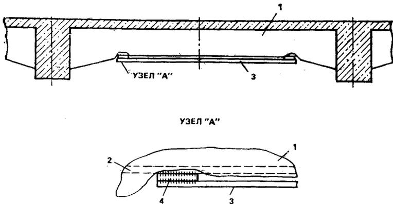
Рис. 30. Усиление балки дополнительной предварительно напряженной арматурой
