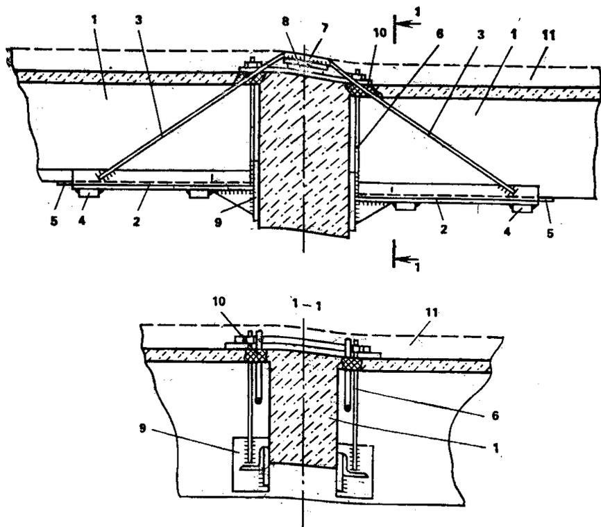
**Рис. 29. Усиление второстепенных балок предварительно напряженными разгружающими кронштейнами**
