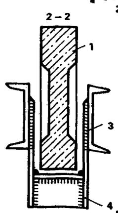
предварительно напряженными разгружающими кронштейнами: 1 — усиливаемая балка; 2 — уголки нижнего пояса кронштейна; 3 — тяжи кронштейна; 4 — колонна; 5 — натяжные болты; 6 — связи по нижнему поясу; 7 — оголовник; 8 — плиты покрытия; 9 — распределительная прокладка; 10 — опорный лист; а — выносными опорами: 1 — усиливаемая балка; 2 — опора; 3 — двухконсольные металлические балки; 4 — столик выносной опоры; 5 — соединительный стержень
