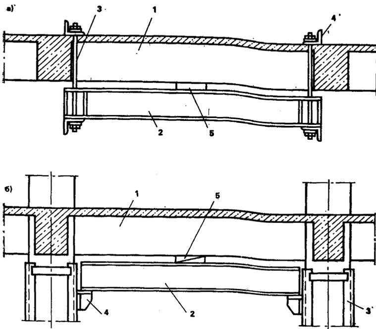
Рис. 23. Усиление дополнительной упругой опорой (металлической балкой)
