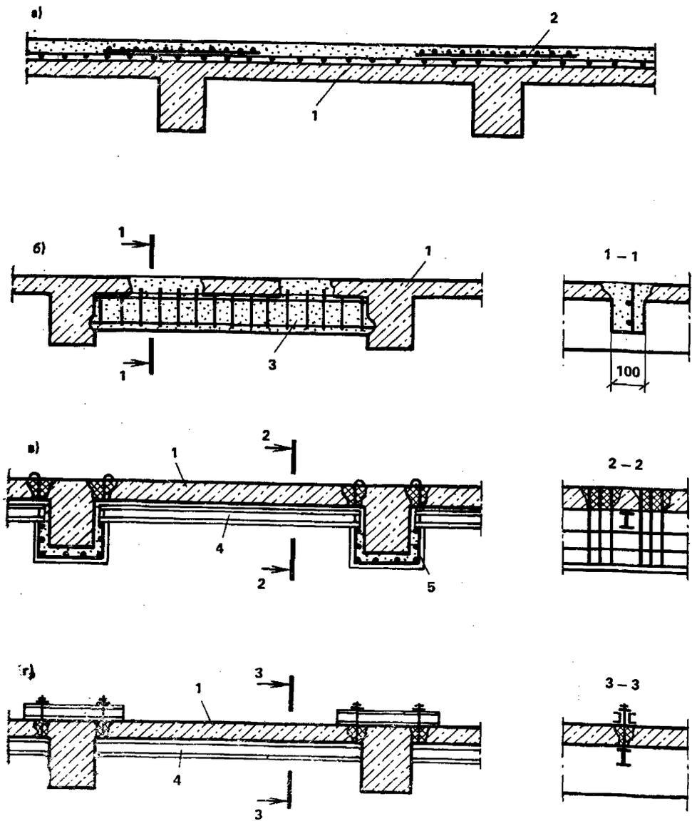
**Рис. 45. Усиление монолитных ребристых плит перекрытий**
