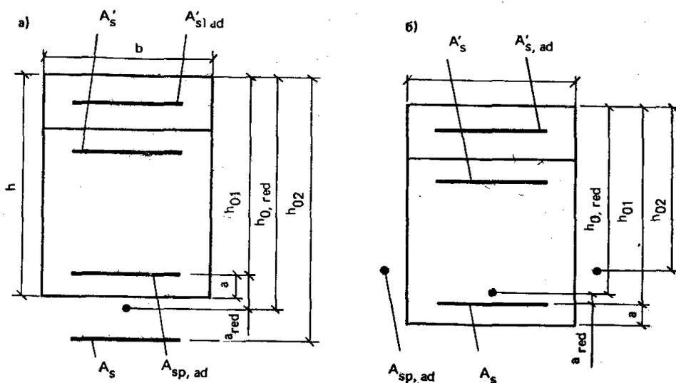
Рис. 61. Расположение центра тяжести арматуры усиливаемого элемента и дополнительной напрягаемой арматуры при расположении ее  $a$  — под нижней плоскостью усиливаемого элемента;  $b$  — по боковым сторонам усиливаемого элемента
