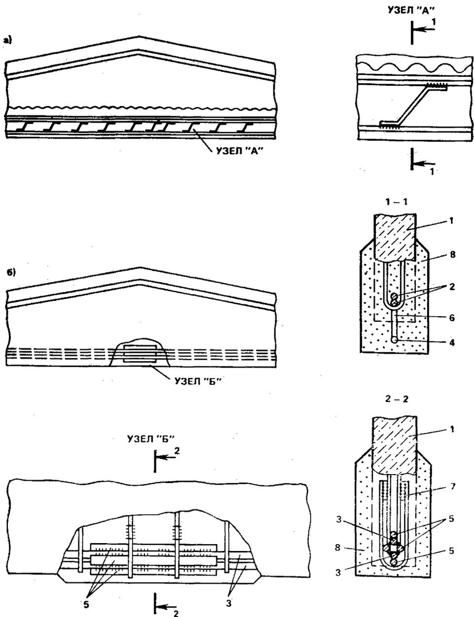
**Рис. 19. Усиление сборных балок покрытия**
