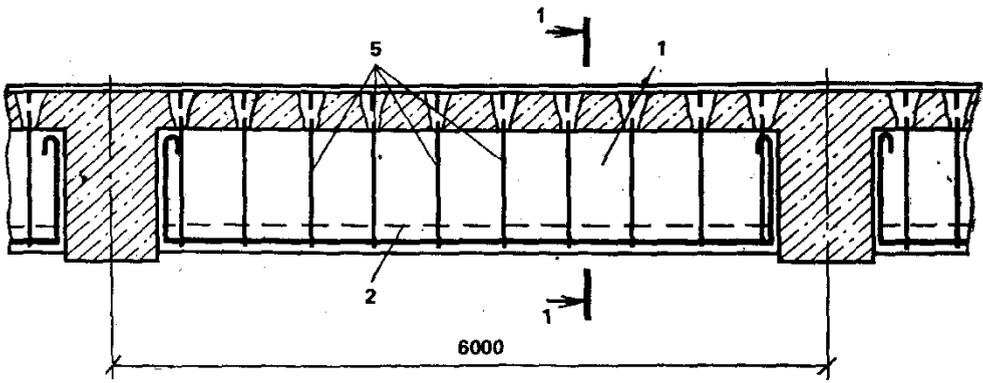
**Рис. 14. Усиление монолитной балки железобетонной рубашкой**
