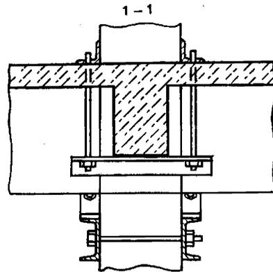
главных балках в местах деформационных швов, рекомендуется производить специальными приспособлениями из металлических элементов, которые представляют собой дополнительные консоли, подвешиваемые к колоннам или главным балкам (см. рис. 39). Соединения отдельных элементов приспособлений осуществляются как на болтах, так и на сварке. Для установки приспособлений в плите перекрытия необходимо пробивать отверстия, которые после установки должны быть заделаны пластичным бетоном на мелком заполнителе.
