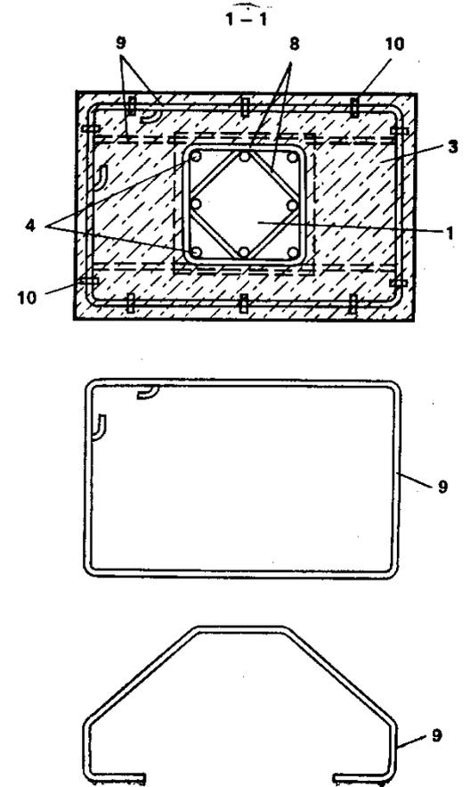
**Рис. 9. Конструкция опорного хомута**
