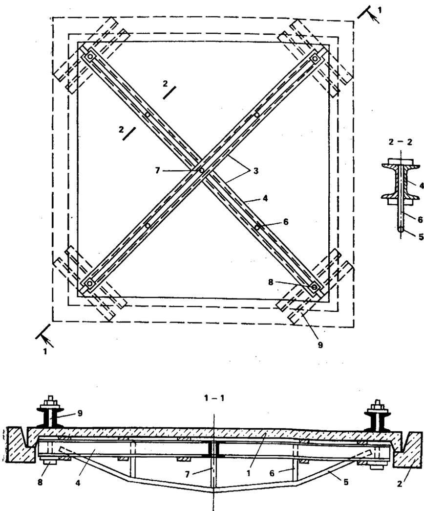
**Рис. 49. Усиление сборной плиты, опертой по контуру, пространственным шпренгелем**
