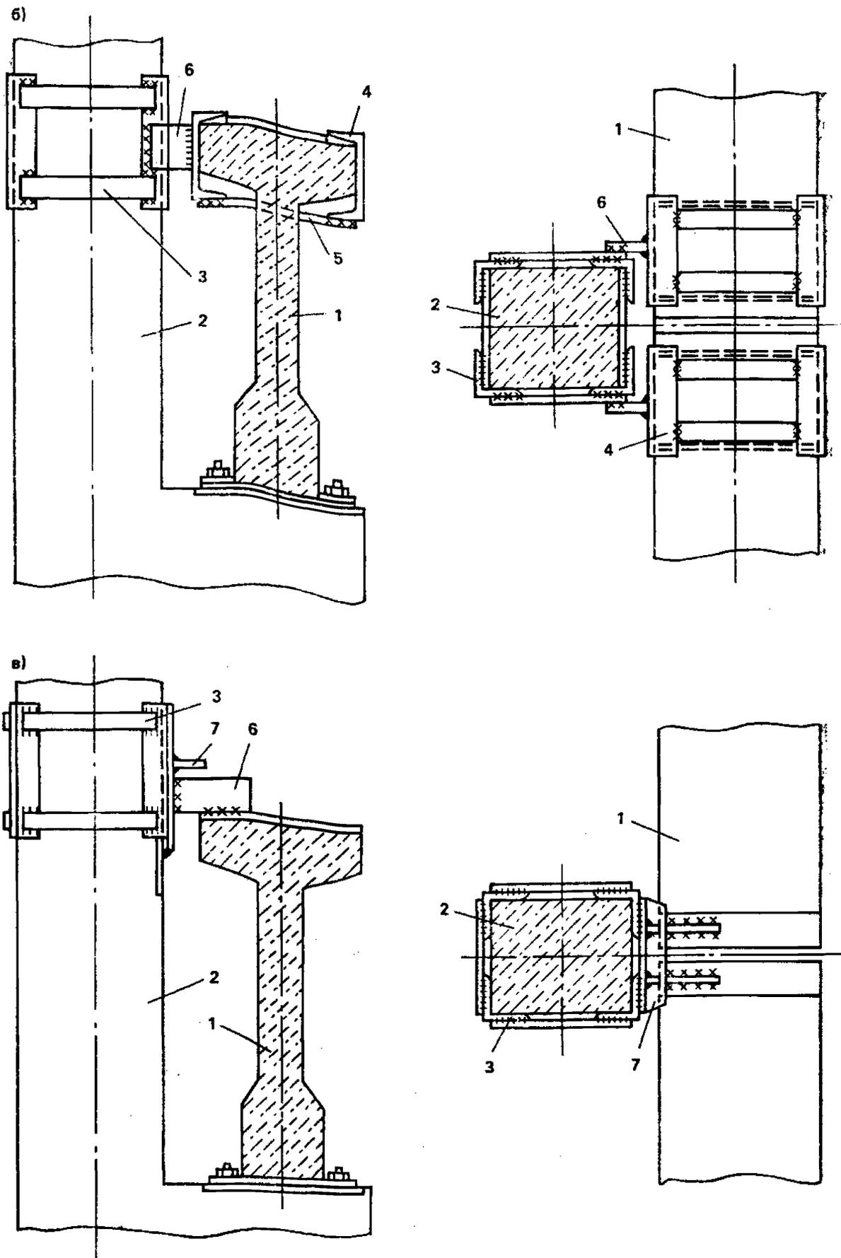
**Рис. 53. Усиление крепления подкрановой балки к колонне**
