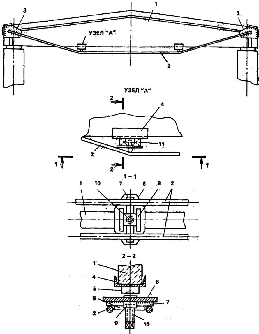
д — шпренгелем: 1 — усиливаемая балка; 2 — шпренгель; 3 — анкерное устройство; 4 — опорный швеллер; 5 — подкладка с шаровым гнездом; 6 — опорный лист; 7 — прокладка из круглых стержней; 8 — квадратная подкладка; 9 — гайка, вваренная в опорный лист; 10 — натяжной винт; 11 — пакет металлических прокладок
