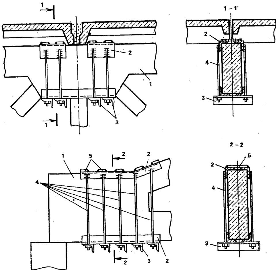
Рис. 44. Усиление средних и опорных узлов ферм
