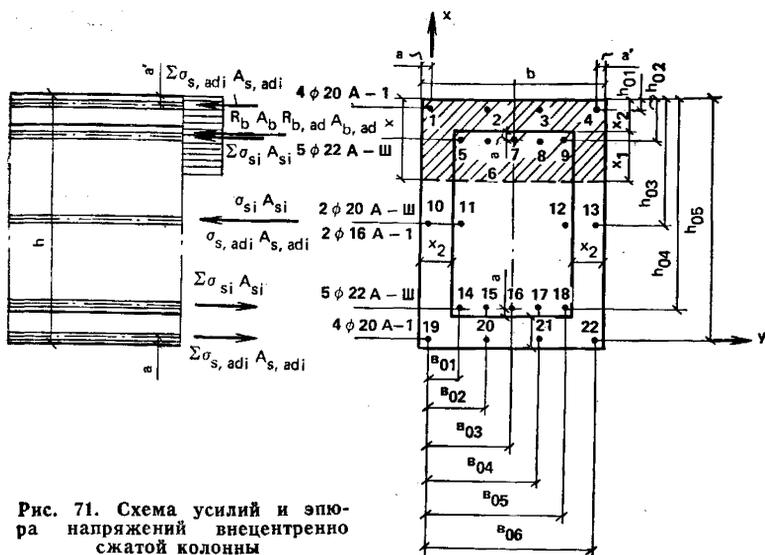
Рис. 71. Схема усилий и эпюра напряжений внецентренно сжатой колонны
