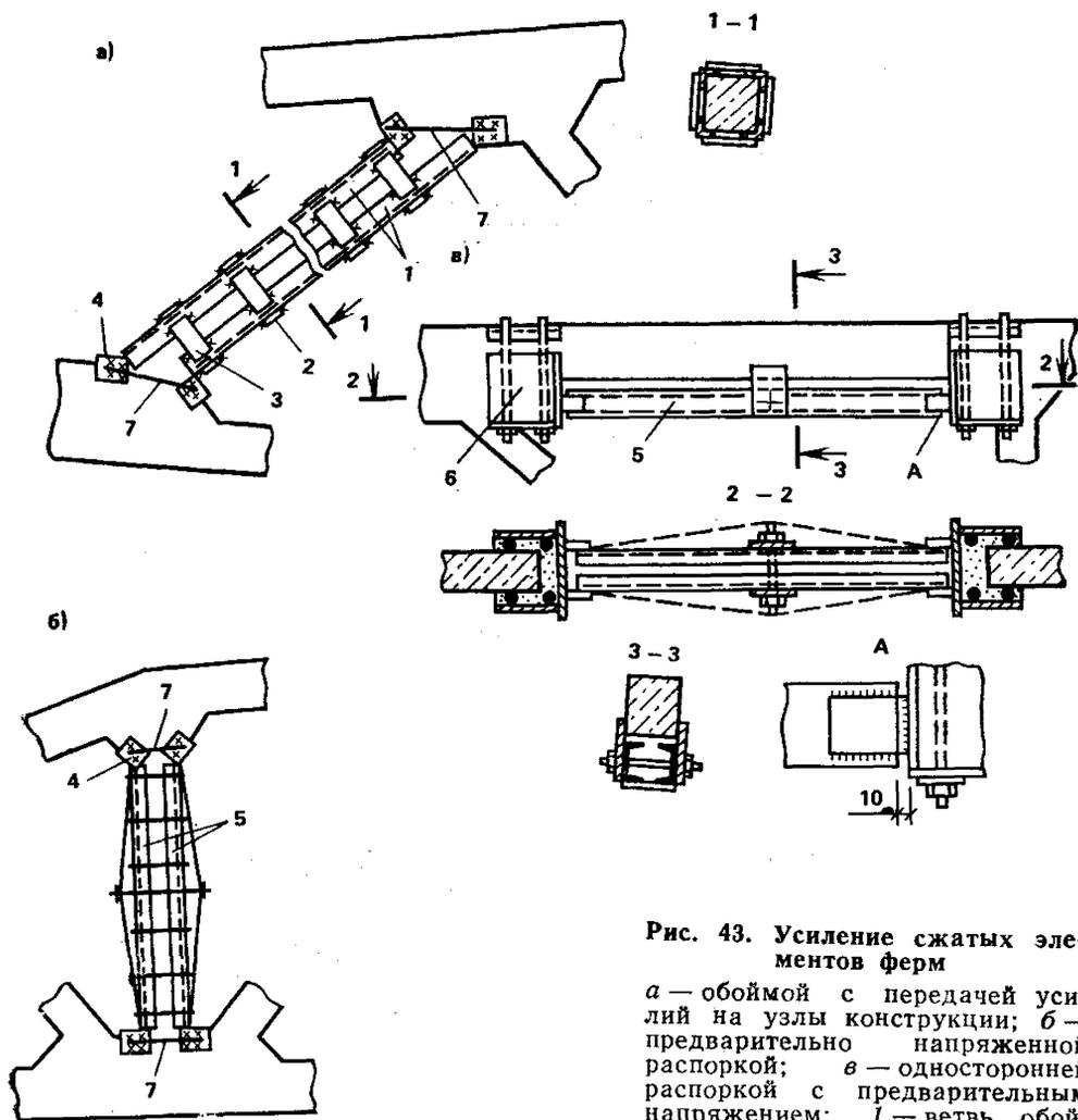
**Рис. 43. Усиление сжатых элементов ферм**
