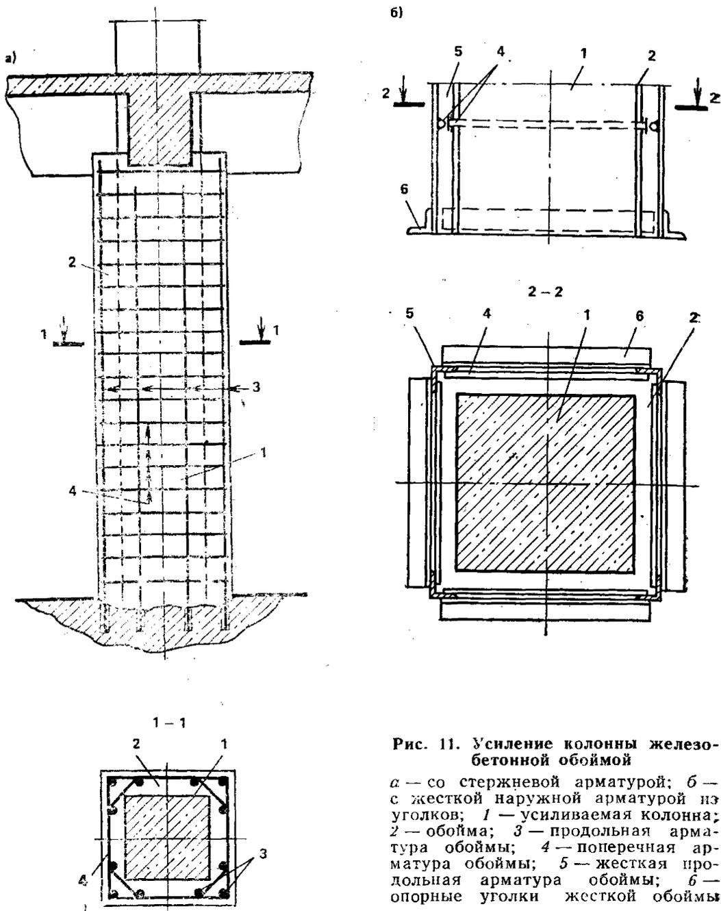
Рис. 11. Усиление колонны железобетонной обоймой
