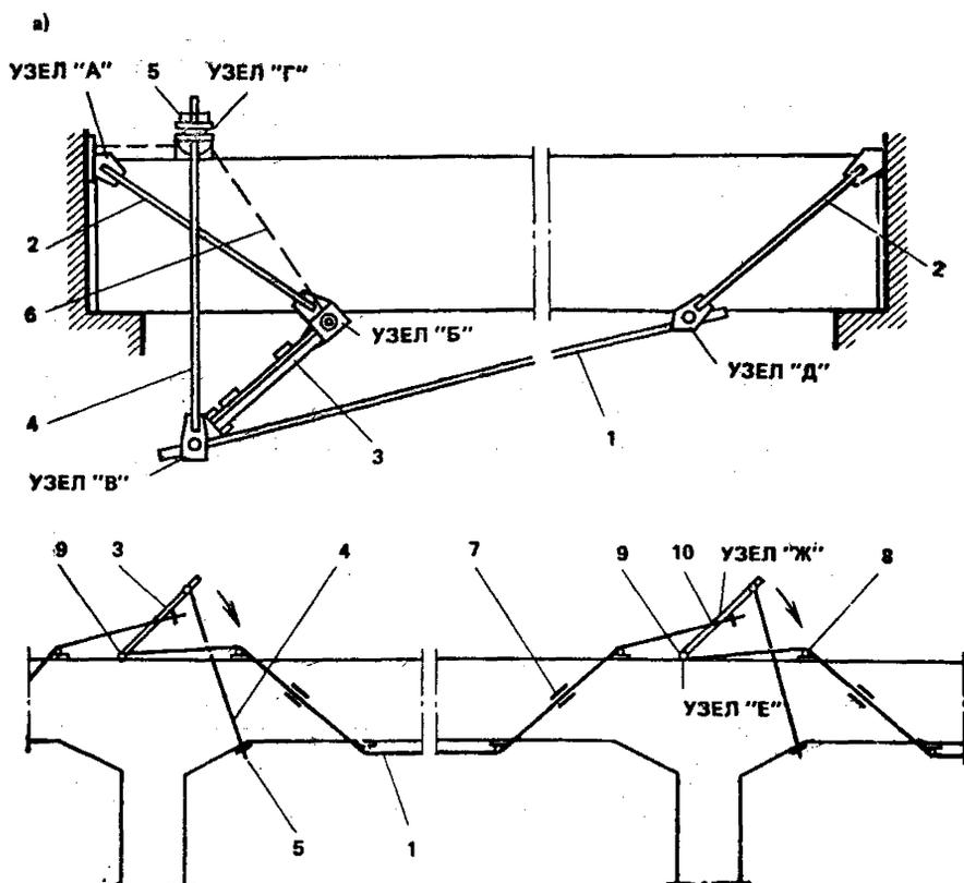
**Рис. 32. Специальные усиливающие устройства для изгибаемых элементов**
