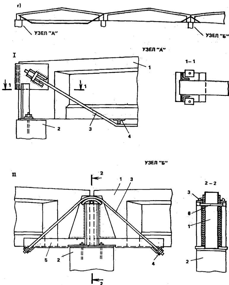
2 — подпружинными системами: I — крайних пролетов — шпренгелем; II — средних пролетов — разгружающими кронштейнами; 1 — усиливаемая балка; 2 — опора; 3 — шпренгель; 4 — упоры; 5 — уголок; 6 — соединительная стяжка;
