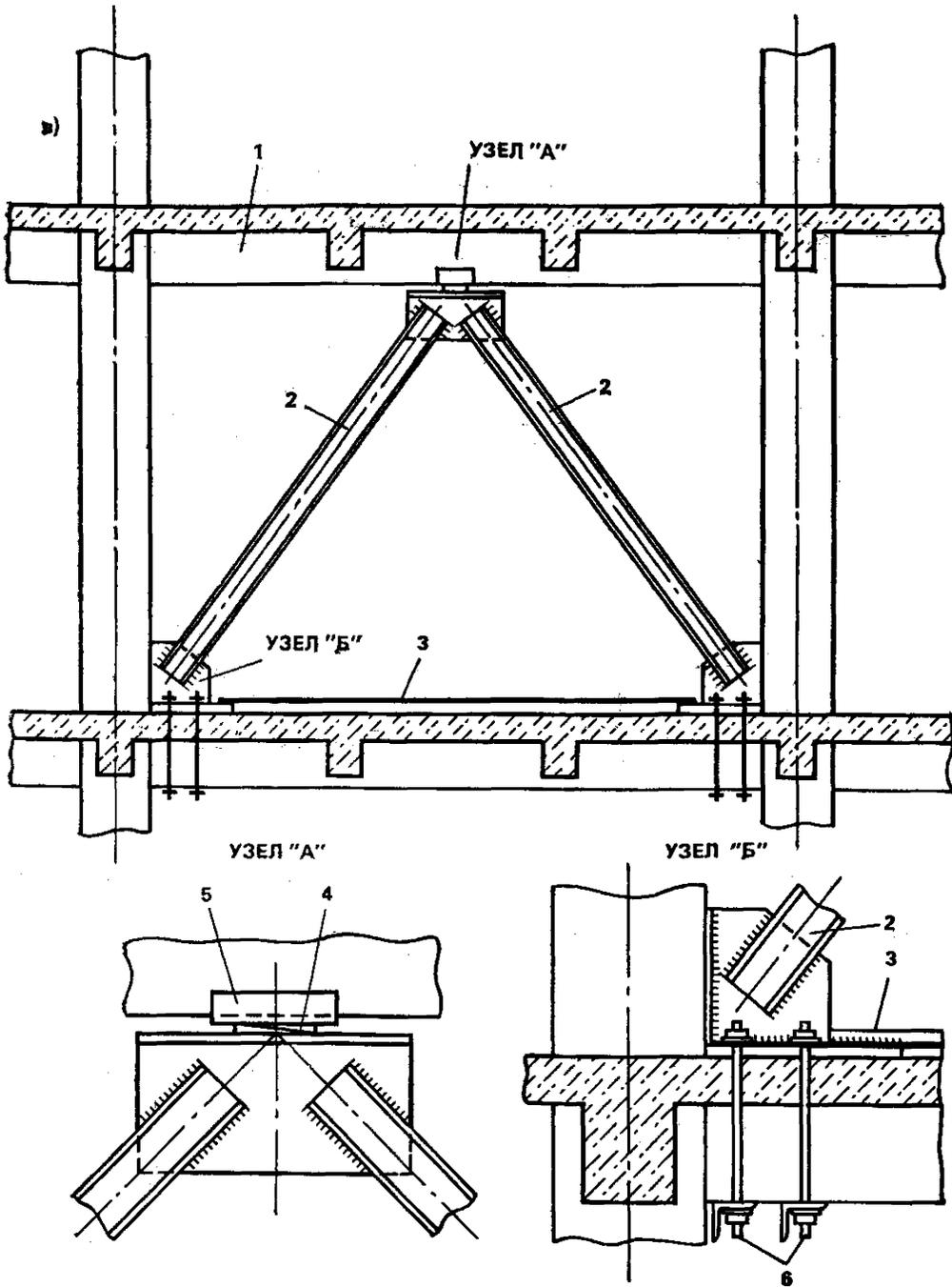
**Рис. 20. Усиление дополнительной жесткой опорой**
