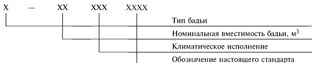
Пример условного обозначения бадьи проходческой для механизированной разгрузки, номинальной вместимостью 4,5 м<sup>3</sup>, для климатического исполнения У:
