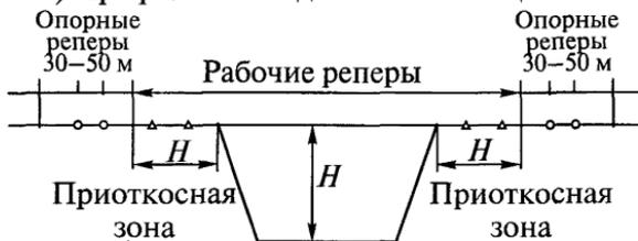
**Рис. 3.** Схема к составлению проекта наблюдательной станции при открытом способе строительства подземного сооружения
