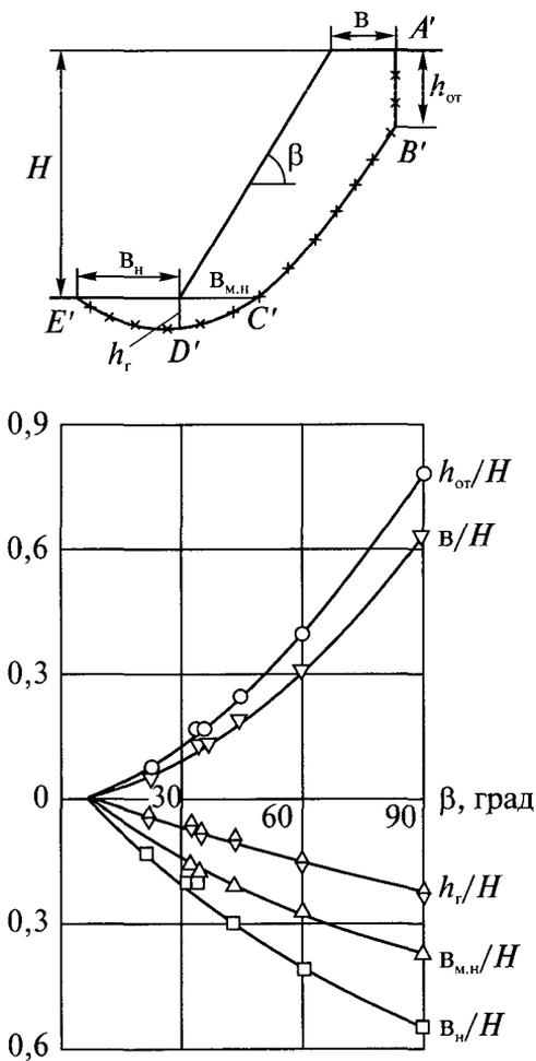
Рис. 3. Определение местоположения наиболее вероятной поверхности скольжения
