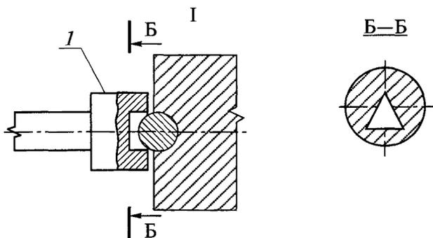
Рис. 9. Индикаторный измеритель деформаций:
