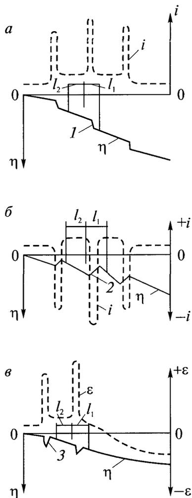
**Рис. 6.** Виды сосредоточенных деформаций земной поверхности:
