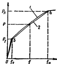
Для монолитных перекрытий с квадратными капителями ломаного очертания при квадратной сетке колонн каркаса, спроектированных в соответствии с настоящим Руководством и «Руководством по расчету статически неопределимых железобетонных конструкций» величину прогиба центра панели<sup>1</sup> при отсутствии трещин в конструкции рекомендуется определять по формуле
