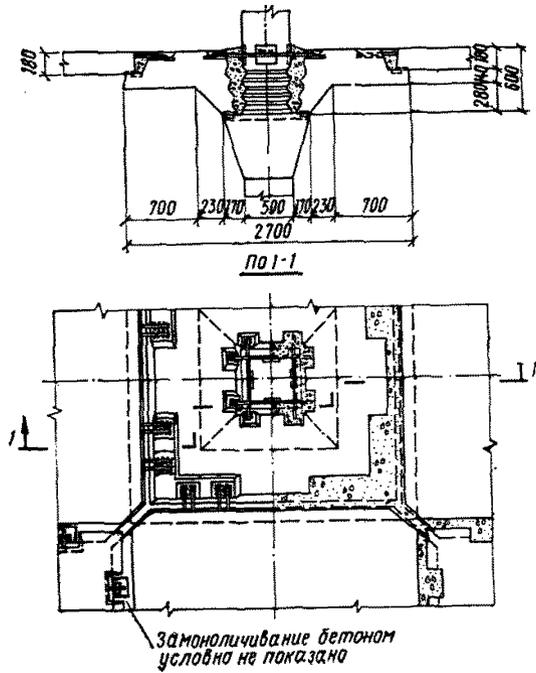
Рис. 16. Расчетная схема незамоноличеного сопряжения капители с колонной
