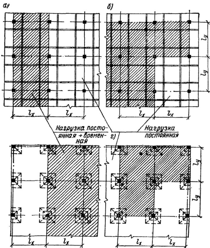
Рис. 5. Возможные схемы загрузки перекрытий
