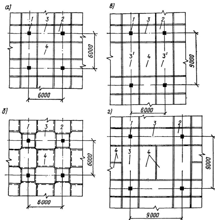
Рис. 4. Схемы разрезки безбалочных перекрытий на сборные элементы:
