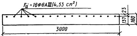
Рис. 28. Верхняя растянутая арматура в сечении по оси  $x$  межколонной плиты
