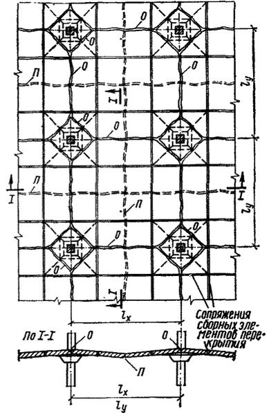
Рис. 7. Схема расположения пластических шарниров при одновременном изломе смежных панелей (плит) перекрытия (на примере сборного перекрытия)
