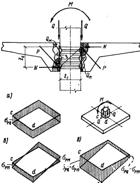
Рис. 18. Расчетная схема замоноличенного сопряжения капители с колонной при несимметричном нагружении
