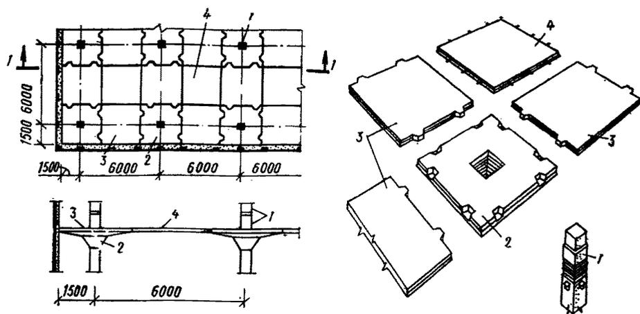
Рис. 13. Сборная безбалочная конструкция со шпуночными сопряжениями элементов (авторское свидетельство № 212499)
