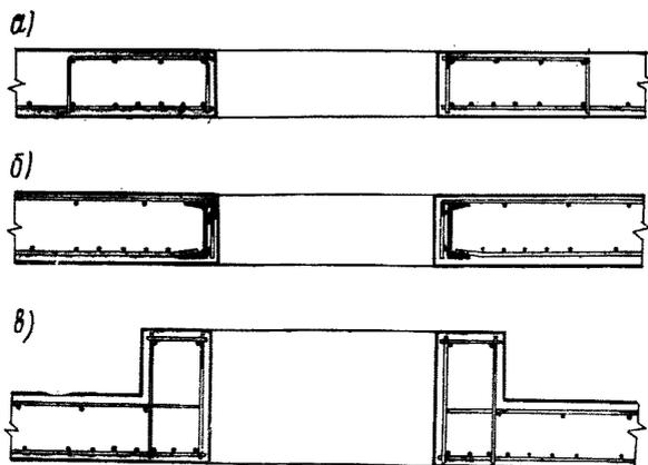
Рис. 21. Примеры конструирования плит перекрытия в местах отверстий
