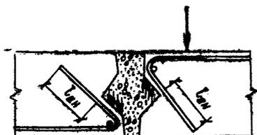
Рис. 20. Соединение сборных элементов при помощи бетонных шпорок
