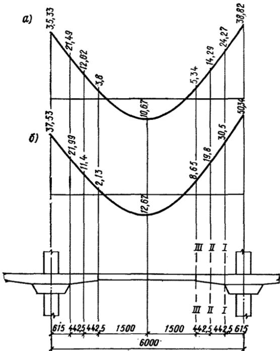
Рис. 22. Эпюры изгибающих моментов в ригеле рамы каркаса
