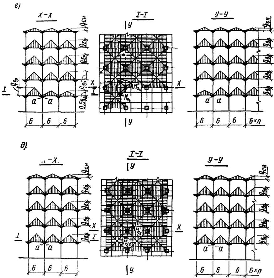
Рис. 30. Схемы загрузки каркаса
