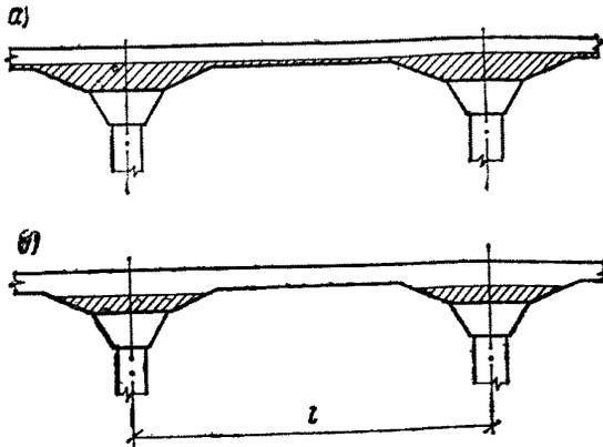
Рис. 12. Положение сжатой зоны в опорных пластических шарнирах при полосовом разрушении перекрытия
