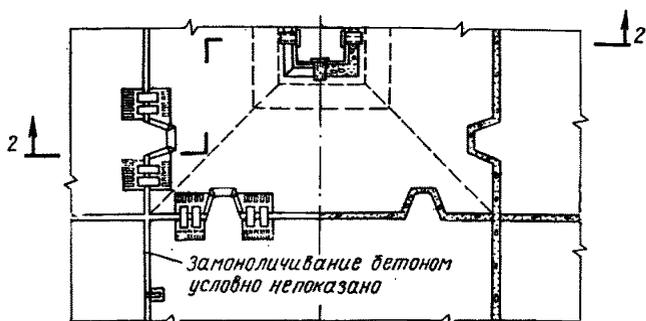
Рис. 14. Узел сопряжений конструкции (авторское свидетельство № 212499)
