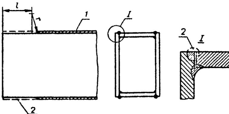
Рис. 6. Схема обработки усиления стыкового шва в замыкании горизонтального и вертикального листов элемента коробчатого сечения:
