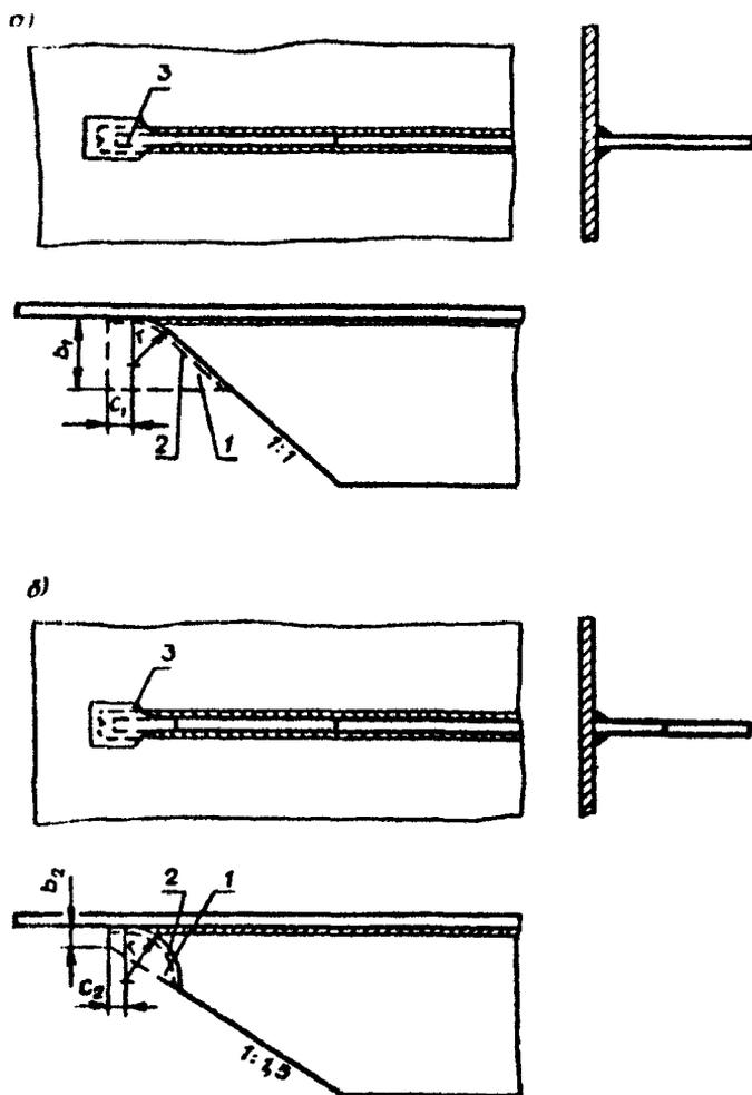
Рис 13. Схема обработки концов фасонок связей, привариваемых к плоскости листа втавр:
