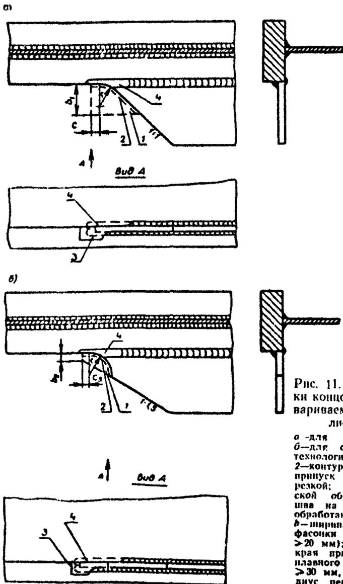
Рис. 11. Схема обработки концов фасонков, привариваемых к кромке листа встык:
