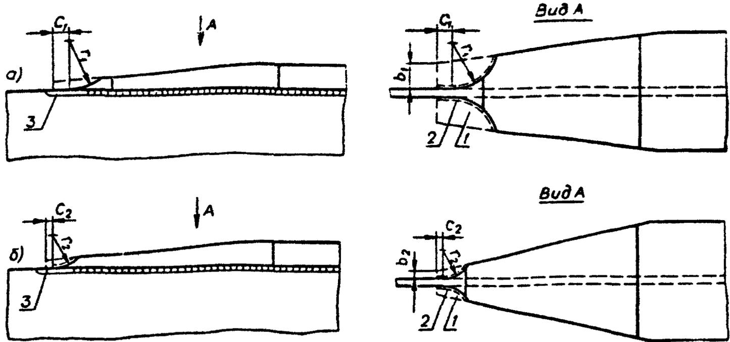
Рис. 18. Схема обработки концевых участков скосов в полках, в случае обрыва полок сварного элемента Н-образного или двутаврового сечения не у торца элемента:
