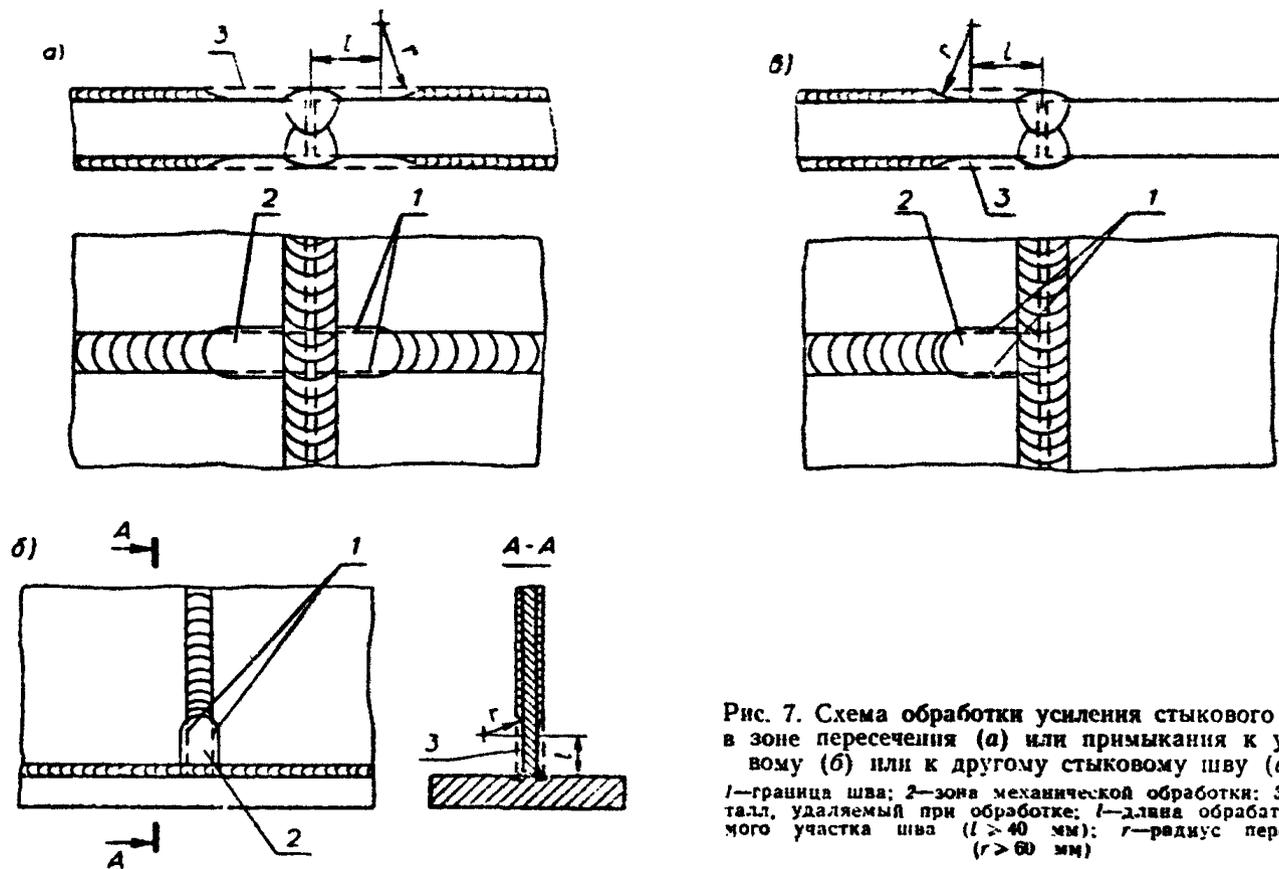
Рис. 7. Схема обработки усиления стыкового шва в зоне пересечения (а) или примыкания к угловому (б) или к другому стыковому шву (с):
