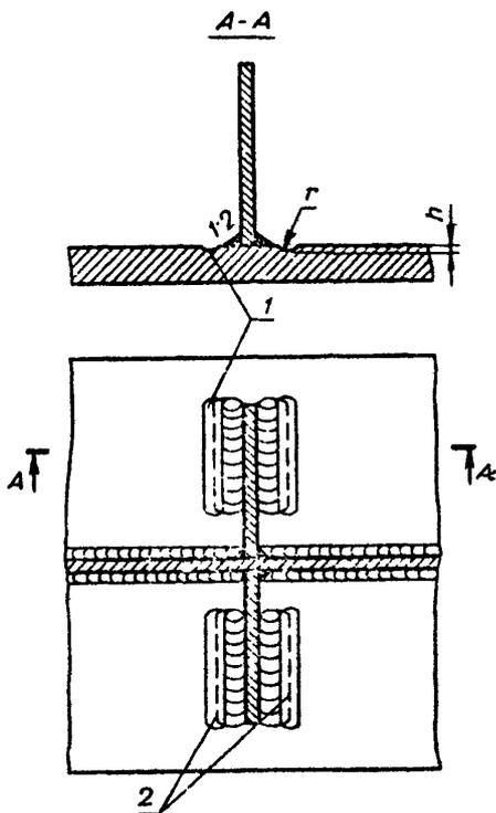
5.5. Выполненные ручной сваркой поперечные угловые швы, прикрепляющие вертикальные ребра жесткости, диафрагмы или фасонки поперечных связей к растянутому элементу или поясу сплошной балки в пролете, обрабатывают в соответствии с указаниями, приведенными на рис. 24.
