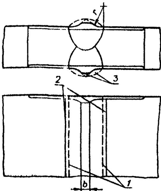
Рис. 2. Схема зачистки острого гребня на усиленном стыковом шве после получения плавных переходов:
