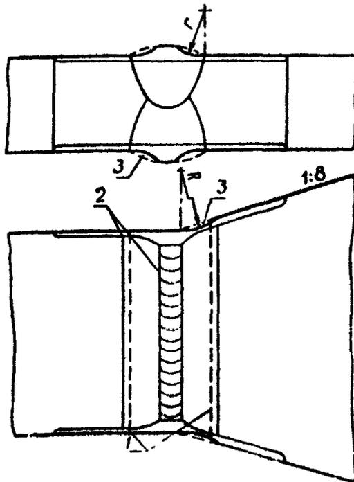
Рис. 4. Схема обработки стыкового соединения листов разной ширины:
