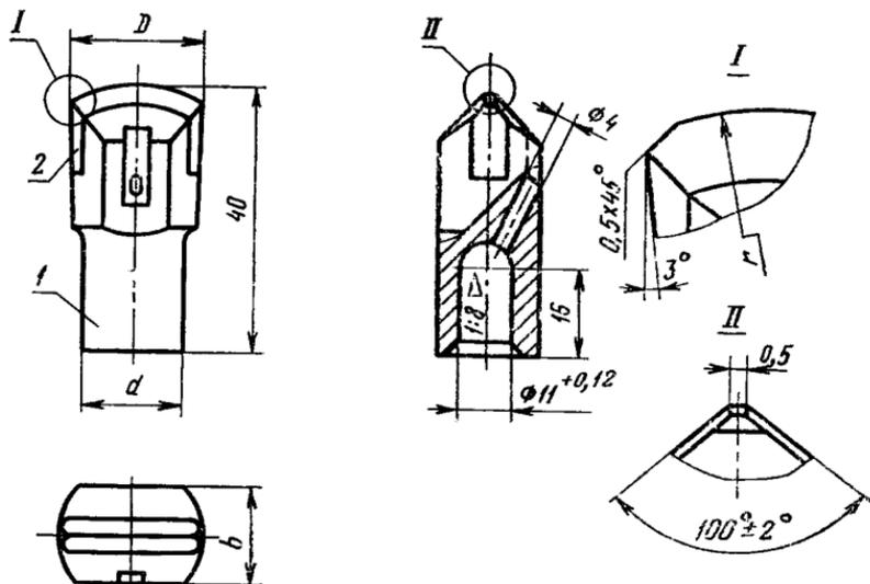
1 — корпус коронки; 2 — пластинка твердосплавная по технической документации, утвержденной в установленном порядке.
