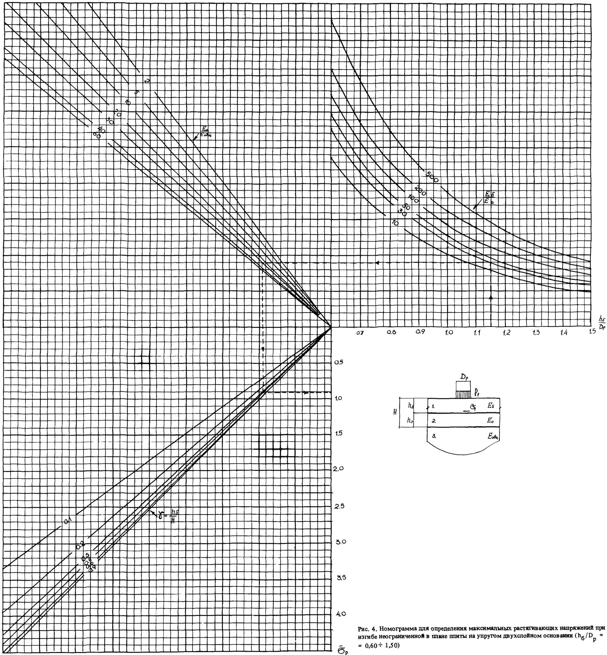
Рис. 4. Номограмма для определения максимальных растягивающих напряжений при изгибе неограниченной в плане плиты на упругом двухслойном основании ( $h_s/D_p = 0,60 \div 1,50$ )
