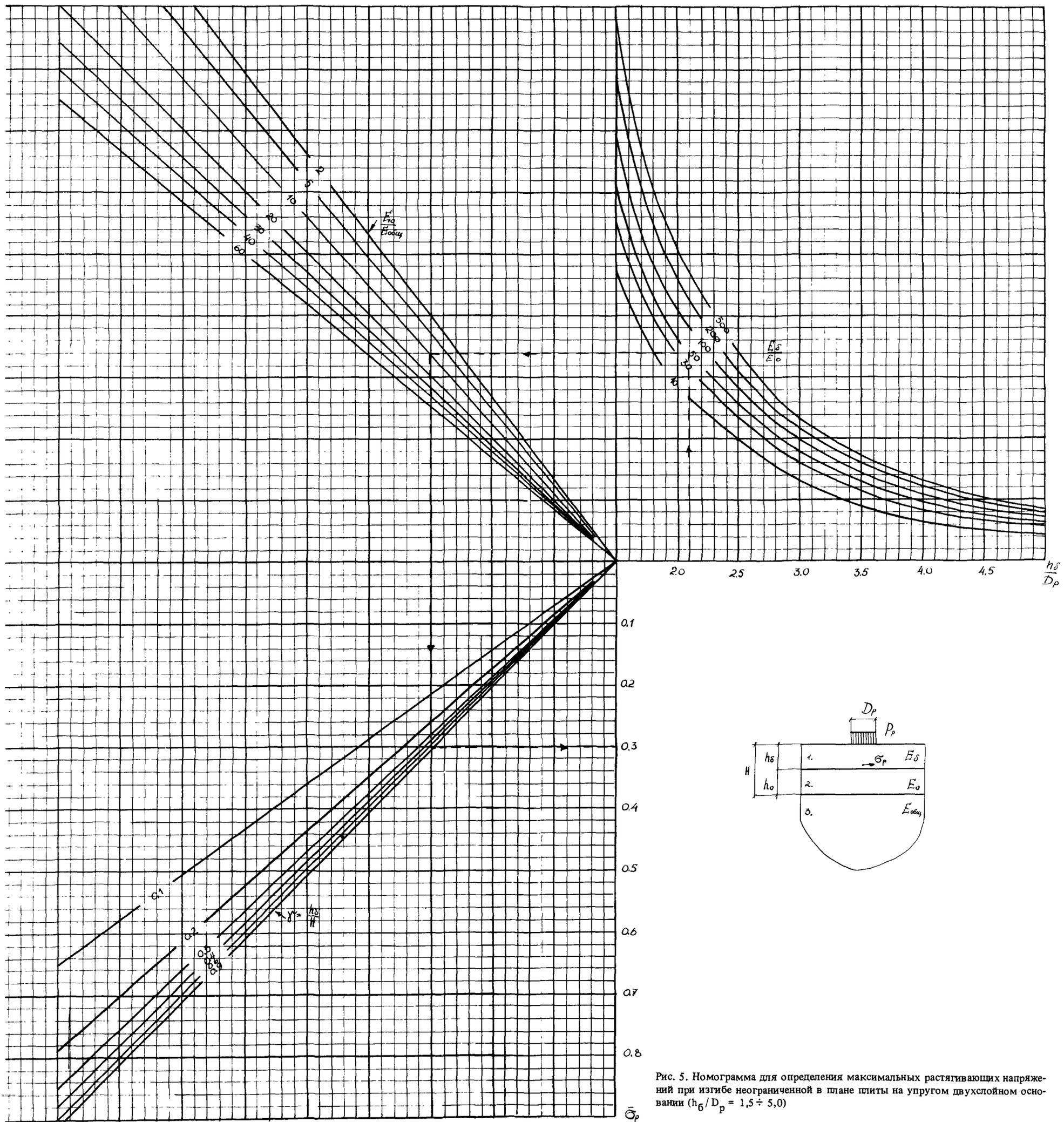
Рис. 5. Номограмма для определения максимальных растягивающих напряжений при изгибе неограниченной в плане плиты на упругом двухслойном основании ( $h_0/D_p = 1,5 \div 5,0$ )
