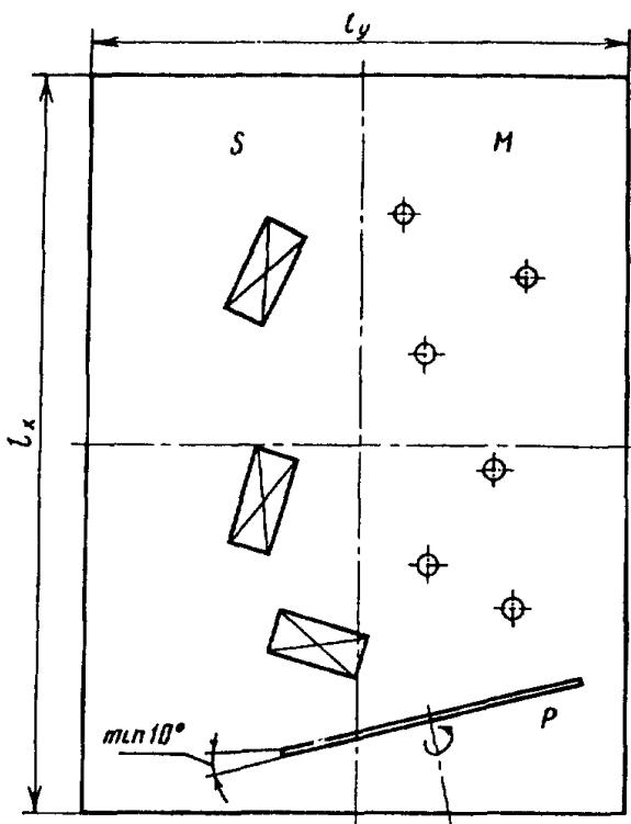
Схема расположения источников шума и точек измерения в реверберационной камере:
