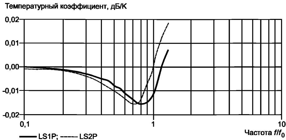
Рисунок Г.2 — Общий вид зависимости температурного коэффициента от частоты для микрофонов типов LS1P и LS2P, вызванной изменением импеданса замкнутого объема воздуха
