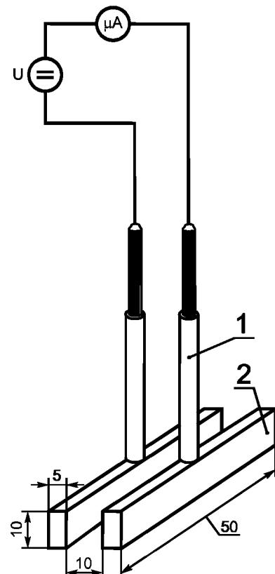
Рисунок 1 — Испытательная установка для определения диэлектрических свойств заполнителя.
