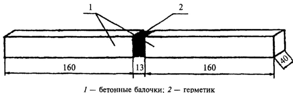
**Рисунок 4** — Образец деформационного шва для определения показателя выносливости
