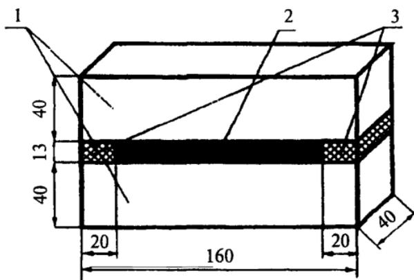
1 — бетонные балочки; 2 — герметик; 3 — деревянные прокладки
