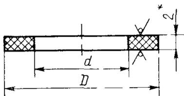
\* Для  $D_y$  1400 мм и более толщина прокладки 3 мм.
