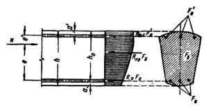
Рис. 8. Схема расположения усилий и эпюра напряжений в поперечном сечении внецентренно сжатото с малым эксцентриситетом железобетонного элемента при расчете его на прочность
