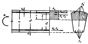
Рис. 3. Схема расположения усилий и эпюра напряжений в поперечном сечении изгибаемого железобетонного элемента при расчете его на прочность
