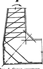
Рис. 6. Схема армирования угловых сопряжений массивных железобетонных конструкций
