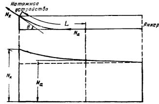
Рис. 1. Схема изменения усилий в напрягаемой арматуре криволинейного очертания для определения потерь предварительного натяжения ее при трении о стенки канала или поверхность бетона конструкции
