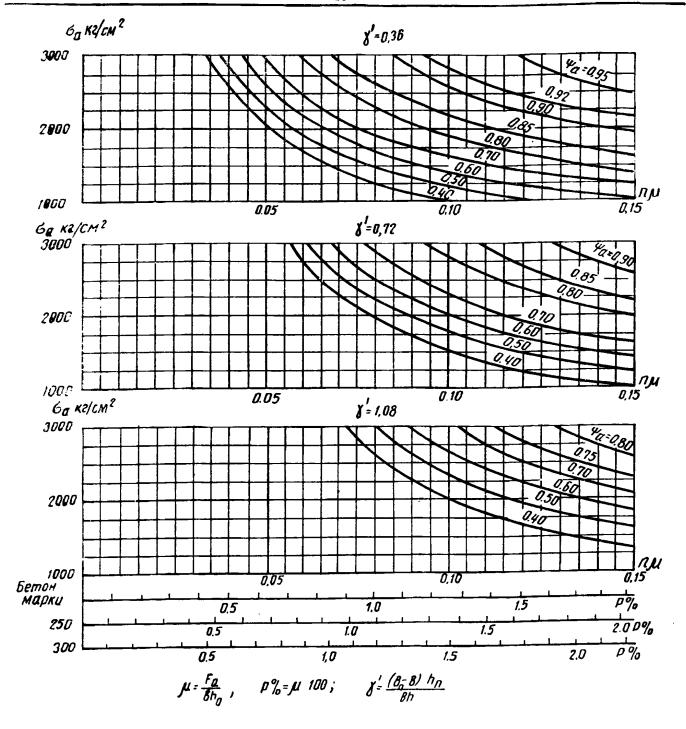
График 4. Изгибаемые элементы двугаврового и коробчатого сечений
