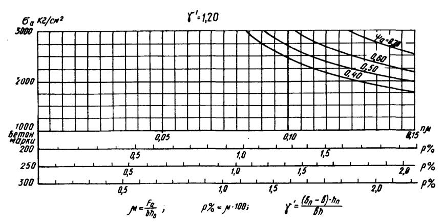
График 3. Изгибаемые элементы таврового сечения с полкой в растянутой зоне
