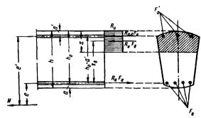
Рис. 10. Схема расположения усилий и эпюра напряжений в поперечном сечении внецентренно растяпутого с большим эксцентриситетом железобетонного элемента при расчете его на прочность
