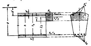
Рис. 7. Схема расположения усилий и элюра напряжений в полеречном сечении внецентренно сжатото с большим эксцентриситетом железобетонного элемента при расчете его на прочность
