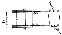
Рис. 9. Схема расположения усилий в поперечном сечении растинутого с малым эксцентриситетом железобетонного элемента при расчете его на прочность
