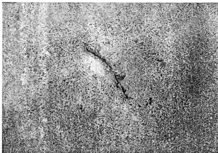
а — темная корочка (внутри заготовки)
