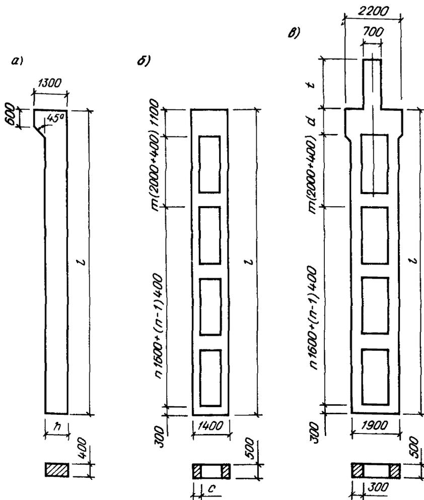
Рис. 4. Опалубочные размеры железобетонных колонн
