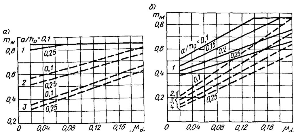
Значения  $m_N$  (а) и  $m_M$  (б) при относительной толщине защитного слоя бетона  $a / h_0 = 0,1 \dots 0,25$  и приведенном к бетону коэффициенте армирования  $\mu\alpha = 0,02 \dots 0,2$
