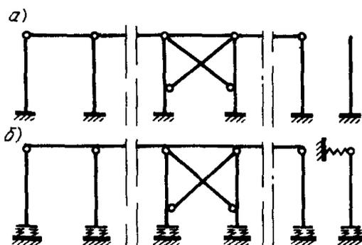
Рис. 3. Расчетная схема эстакады
