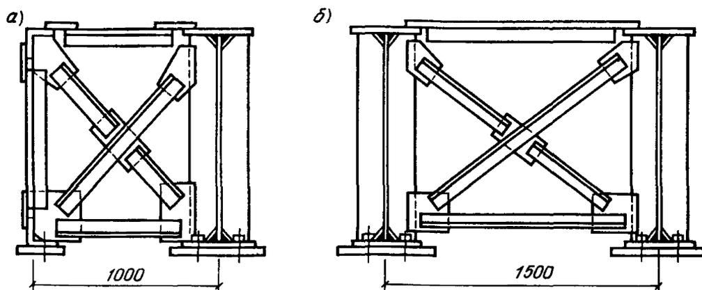
Рис. 9. Рекомендуемая схема блочного решения стальных пролетных конструкций для ряда
